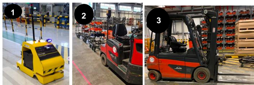
Figura 9 - Meios de movimentação motorizados usados na Renault Cacia (1 - AGV; 2 - Comboio Logístico; 3 - Empilhador)
