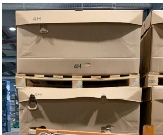
Figura 27 - Embalagens danificadas pelo incorreto empilhamento
