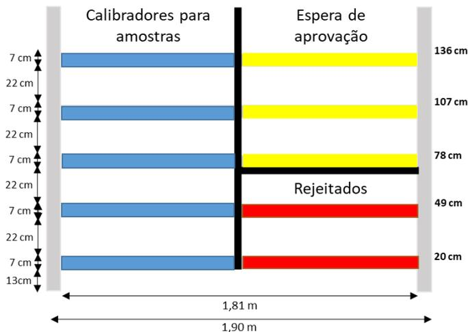
Figura 42 – Desenho do novo layout para a estante de Amostras e Retificação do lado direito
