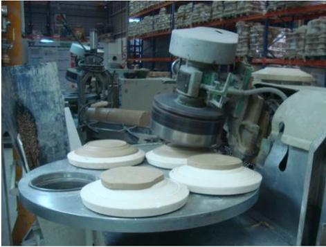
Figura 17 – Roller de conformação externa (pratos)
