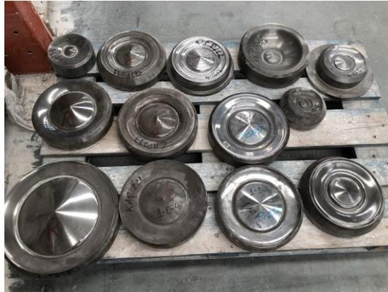
Figura 53 – Marcação e identificação dos calibradores
