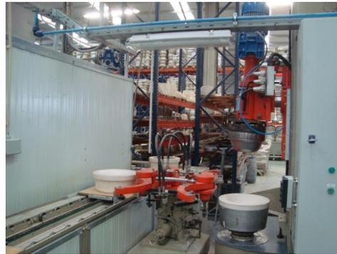
Figura 18 – Roller de conformação interna com robot (saladeiras)
