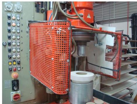
Figura 19 – Roller de conformação interna (canecas)
