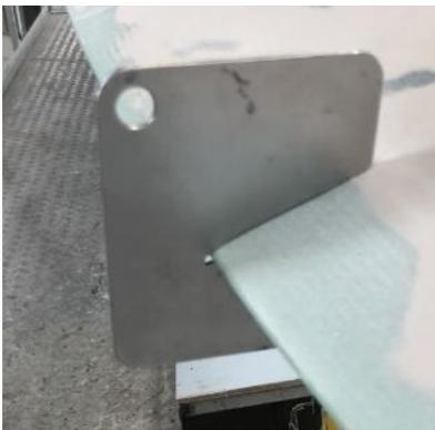
Figura 28 - *Template* de espessura
