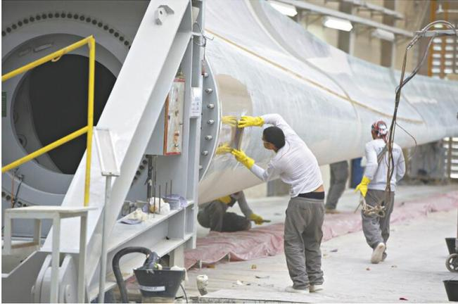
Figura 27 - Exemplo de aplicação de massas [Fonte: Marinho, 2021]
