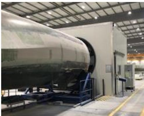
Figura 31 - Pá na *Drilling Machine*
