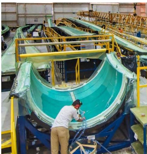
Figura 20 - *Semi-root* com o saco de vácuo [Fonte: (Marinho, 2021)]
