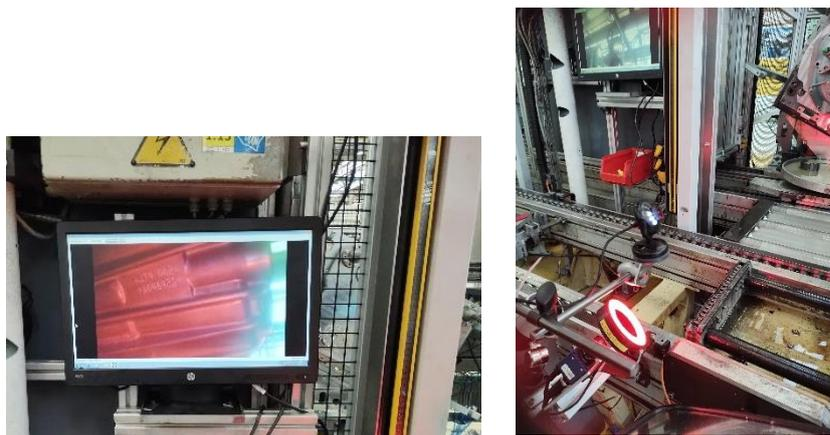
Figura 48- Aplicação de sistema de visão OP645
