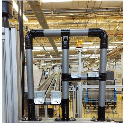
Figura 45- Aplicação de calhas para abastecimento das ogivas
