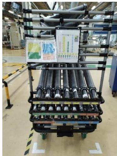
Figura 51- Atribuição de cores ao carro de abastecimento de cales
