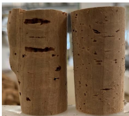
Figura 42 - À esquerda: rolha deformada; à direita: rolha normal
