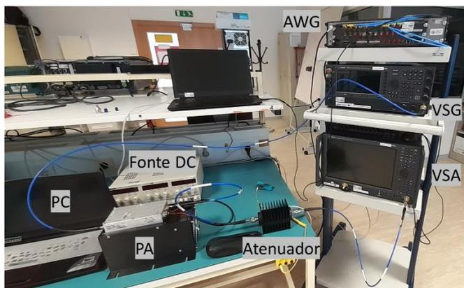
Figura 45 - Constituição da bancada de linearização com o PA comercial para sub-6 GHz.
