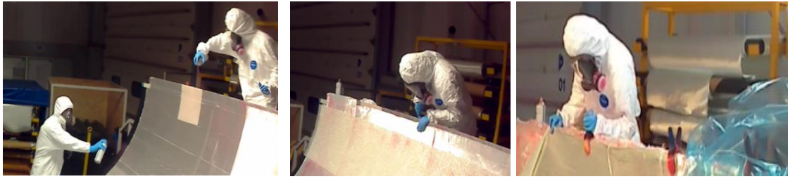
Figura 29: Atividades redundantes durante o layup das semi roots : aplicação de spray , cosedura nas abas laterais e colocação de molas, respetivamente.
