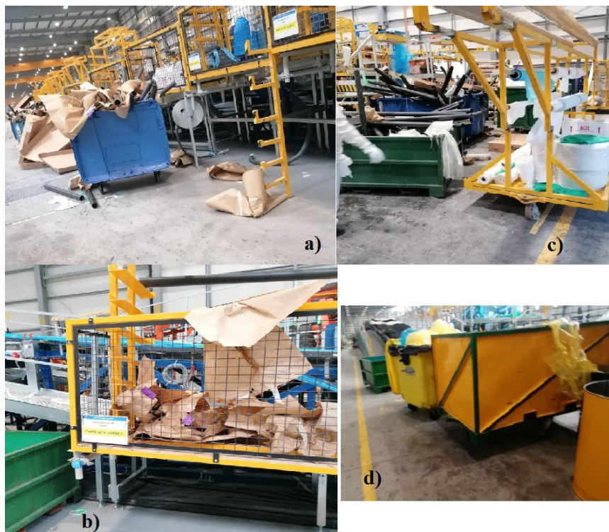
Figura 26: Desorganização inicial da shell SG145: a) existem caixas de cartão no piso e tubos de fibra no papelão; b) o papel foi depositado nas cestas; c) zona da root com resíduos no chão e resíduos mal alocados; d) etapa da ripagem, porém existem dois bidões de resina da fase anterior e o plástico está colocado no sítio errado.
