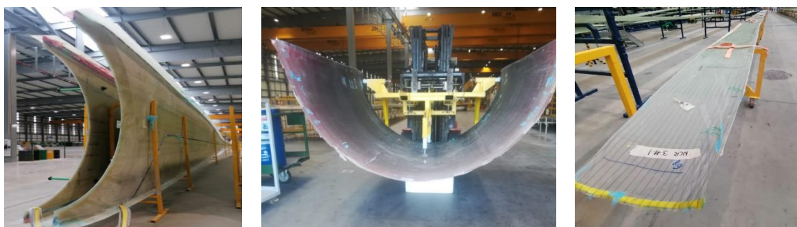
Figura 12: Pré-fabs da pá SG145: webs , semi root e cap respetivamente.
