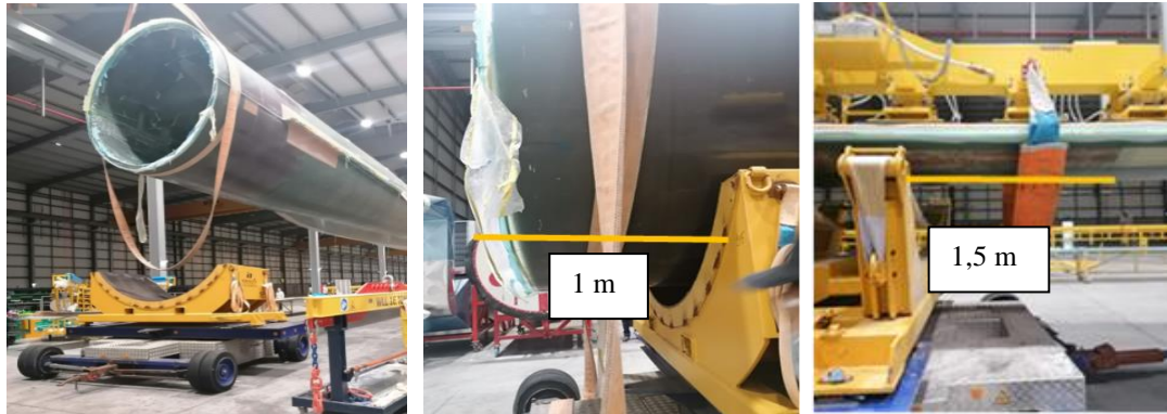
Figura 24: Pá a ser posicionada nos carros (no caso do carro do lado da root , deve respeitar-se a cota de 1m. No que diz respeito ao segundo, este deve estar a 1,5 m da balsa).
