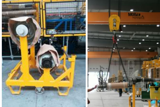
Figura 23: Carro de fibras cosidas e transporte dos rolos para a shell por pontes.
