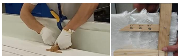
Figura 41: Ferramentas de auxílio: posicionamento de fibras e corte na root , respetivamente.
