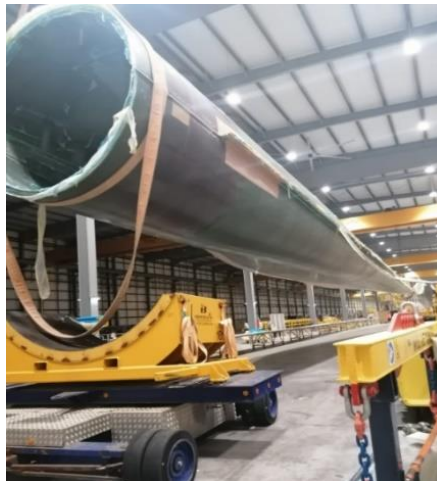
Figura 10: Pá desmoldada e movimentada por pontes suspensas.
