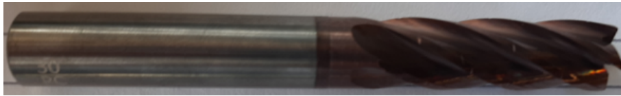
Figura 3.9: Fresa 4: Ângulo de Hélice - 30^\circ , Passo constante
