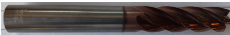
Figura 3.7: Fresa 2: Ângulo de Hélice - 35^\circ , Passo 72-68-76-68
