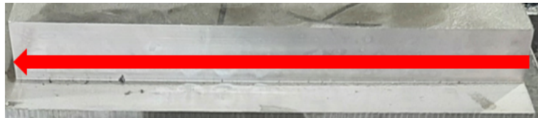
Figura 3.13: Trajetória da ferramenta de corte
