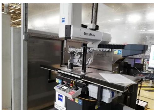
Figura 4.14 - Medição das tolerâncias geométricas na máquina DuraMax.
