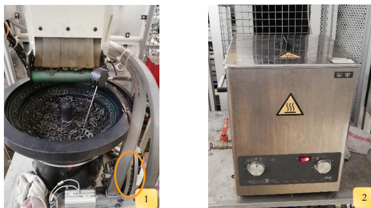
Figura 4.28 - 1. Máquina introdução de anilhas ( Intec ); 2. Máquina de ultrassons para lavagem das anilhas.
