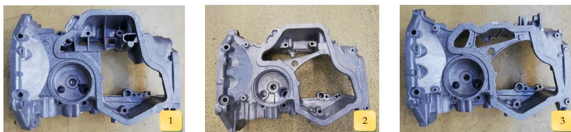
Figura 4.1 - 1. Cárter intermédio em bruto H5FT (Gen1); 2. Cárter intermédio em bruto HR13 4x2 (Gen2); 3. Cárter intermédio em bruto HR13 4x4 (4x4).
