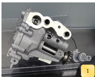
Figura 2.7 - 1. Bomba óleo; 2. Cárter distribuição H4; 3. Coroa JT4.
