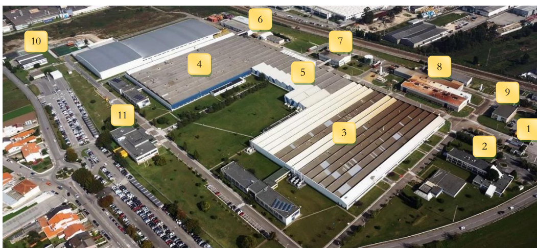
Figura 2.3 - Vista aérea da fábrica Renault Cacia. 1. Receção; 2. Direção/Recursos Humanos; 3. Caixa Velocidades; 4. Componentes Mecânicos; 5. Logística; 6. Oficina Central; 7. Central de Flúidos; 8. Tratamentos Térmicos; 9. ETAR; 10. Campus CCD 11. Cantina/Posto Médico. (Renault Cacia, 2021)
