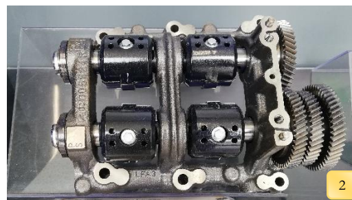
Figura 2.8 - 1. Tampa da culassa. 2. Árvore de equilibragem.
