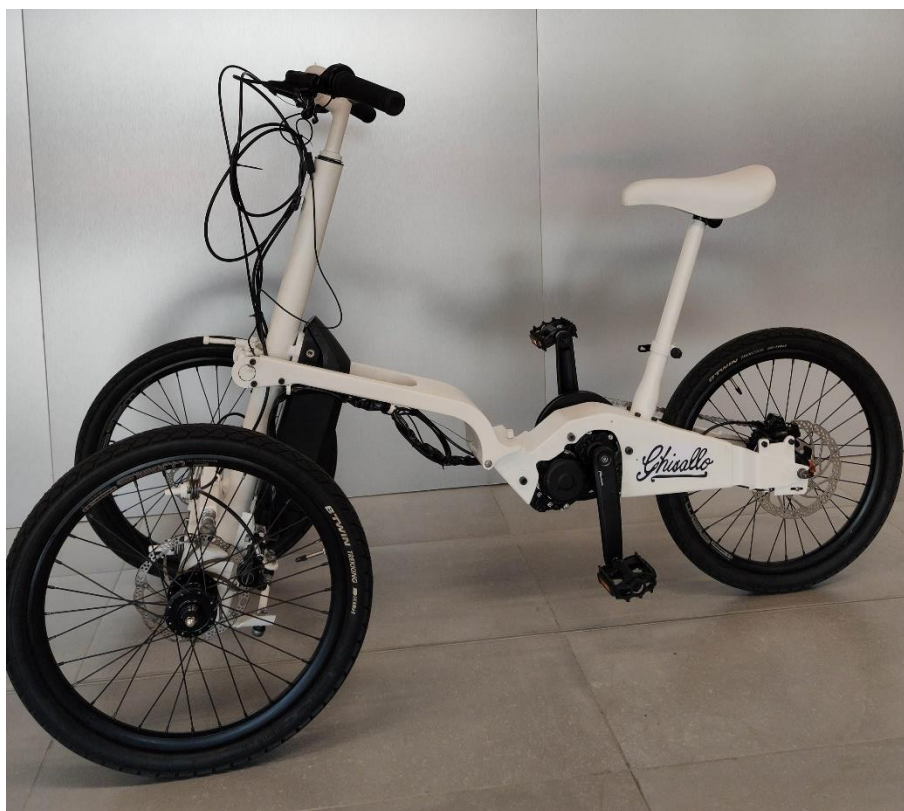
Figura 3.4 Protótipo do veículo Ghisallo (fotografia da autoria de Prof. António Completo)
