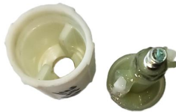
Figura 7b) Mecanismo interno do travão TOYOU
