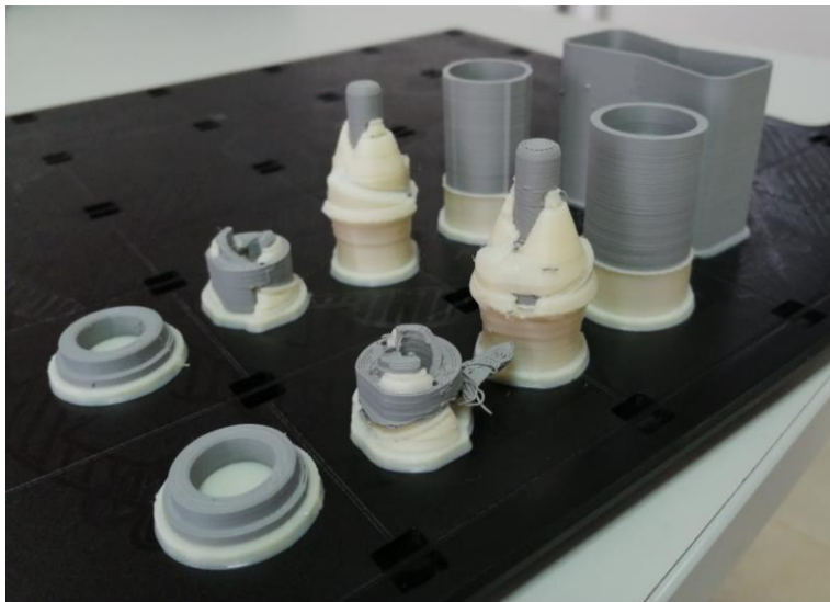
Figura 33 Componentes impressos em 3D em ASA
