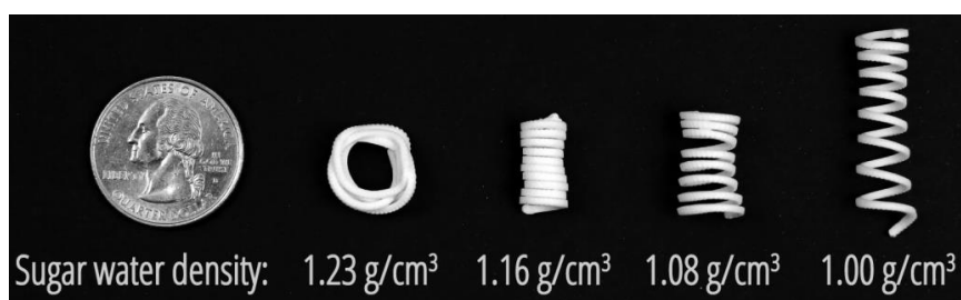
Figura 46 - Efeito da densidade no processo de ativação. Adaptado de: [4].
