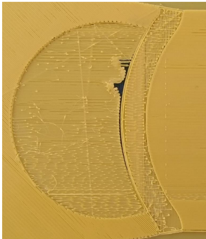
Figura 41 - Detalhes de impressão exemplificativos dos principais obstáculos encontrados.
