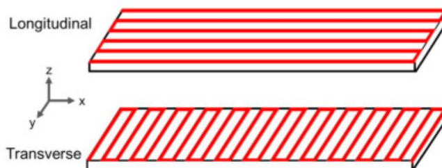
Figura 8 - Tipo de Impressão Longitudinal e Transversal. Adaptado de: [10].
