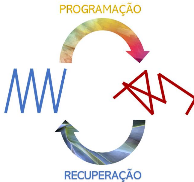
Figura 3 - Representação do processo de memória de forma.
