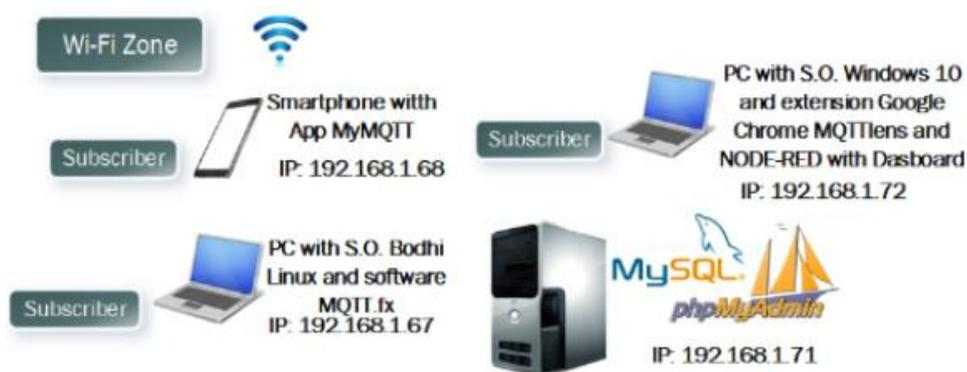
Figura 32 Software e hardware para implementar o servidor MQTT (Malhao et al., 2019)
