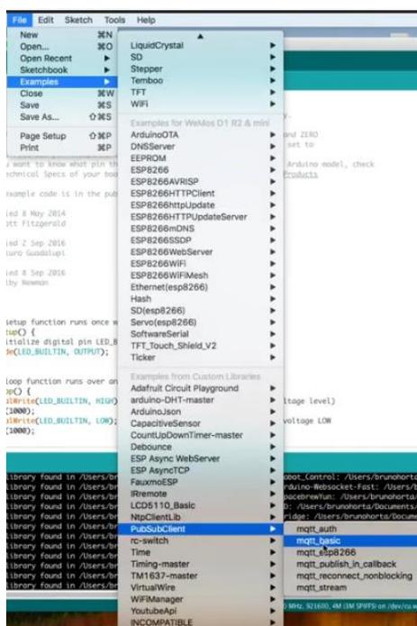
Figura 75 Obtenção do código exemplo para a ligação do ESP a plataformas MQTT
