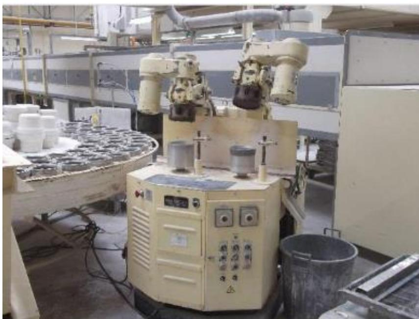
*Figura 7 Máquina roller usada no processo de contramoldagem (Silva, 2014)*
