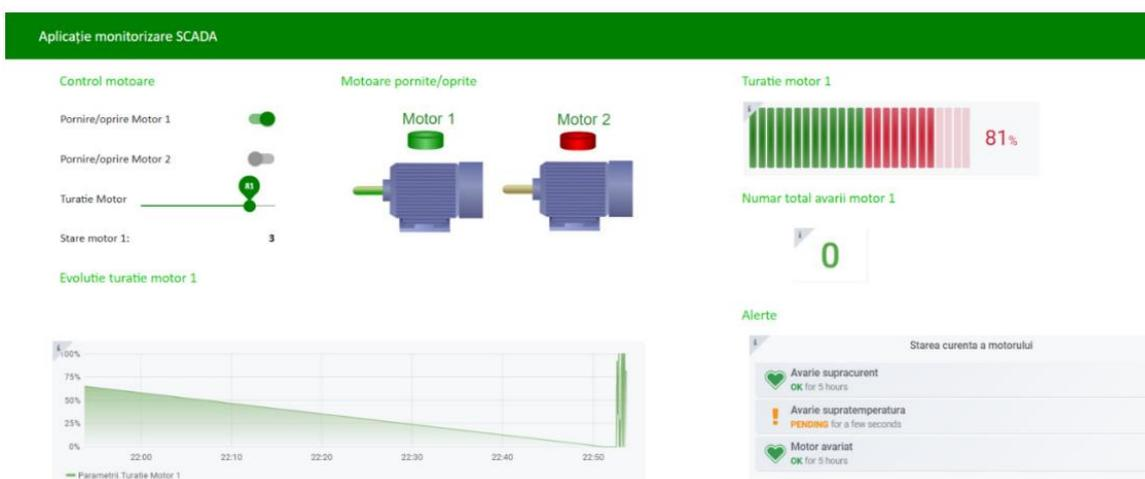
Figura 29 Exemplo de dashboard criado a partir do Node-RED (Nițulescu & Korodi, 2020)
