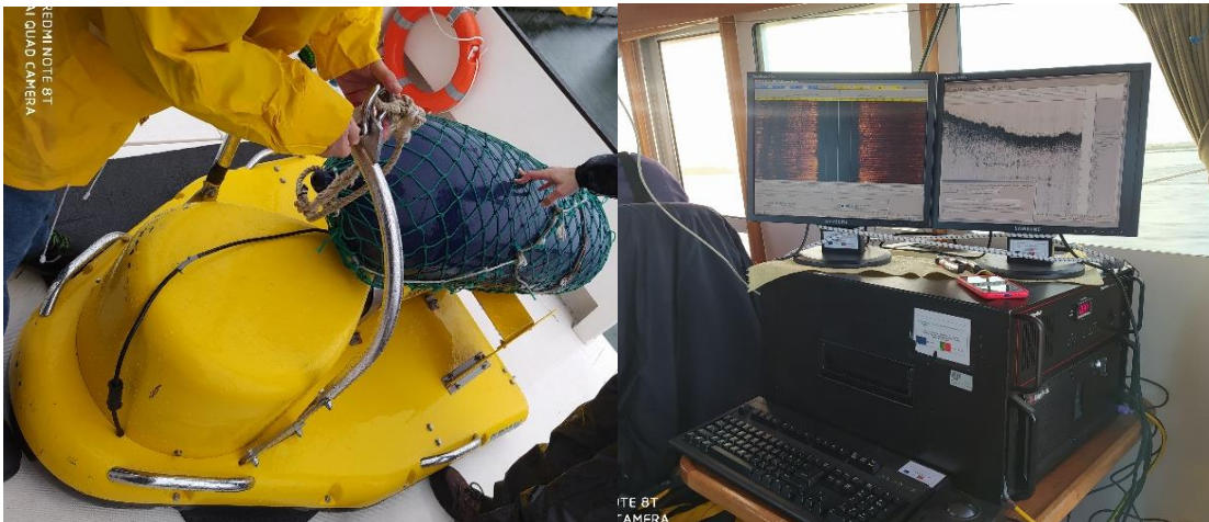
Figura 17: Sistema combinado de sonar varrimento lateral e Chirp Sonar, modelo Edgetech 512i do Laboratório de Geologia e Geofísica Marinha, do Laboratório Associado CESAM e do Departamento de Geociências, da Universidade de Aveiro.
