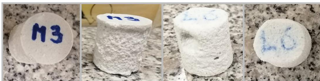
Figura 11 – Aspeto dos provetes mergulhados em ácido acético (M3) e em ácido láctico (L6)
