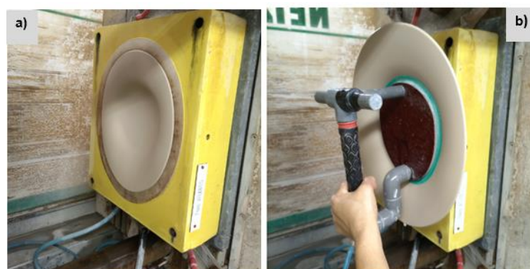
Figura 13 – Imagem de um molde de resina porosa para conformação de peças de porcelana, por enchimento sob pressão: a) peça no fim do enchimento, pronta para ser desmoldada e b) desmoldagem da peça com auxílio duma ferramenta própria, designada por “aparadeira”
