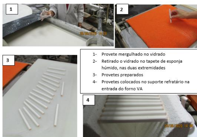
Figura 35 - preparação dos provetes vidrados antes da cozedura: 1- provetes após terem sido mergulhados no vidrado, 2- operação de retirar o vidrado das extremidades do provete; 3- provetes prontos para cozedura, 4- provetes colocados no suporte refratário.
