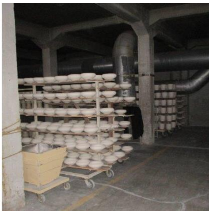
Figura 21 – peças conformadas por enchimento tradicional a secar na estufa.
