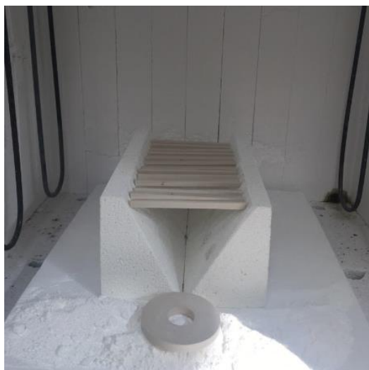
Figura 37 - provetes colocados nos suportes refratários no interior do forno laboratorial UA com anel de medição de temperatura.
