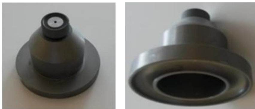
Figura 32 - Taça Ford nº4 utilizada na medição da viscosidade em segundos
