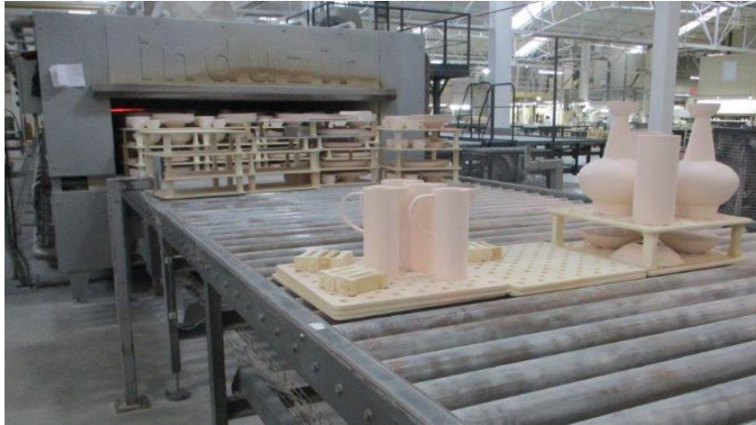
Figura 23 – Peças de porcelana chacotadas, adquirem coloração rosa-claro, à saída do forno de chacote, com temperatura máxima de cozedura, cerca de 1000 °C e ciclo de cozedura entre 10-14 h
