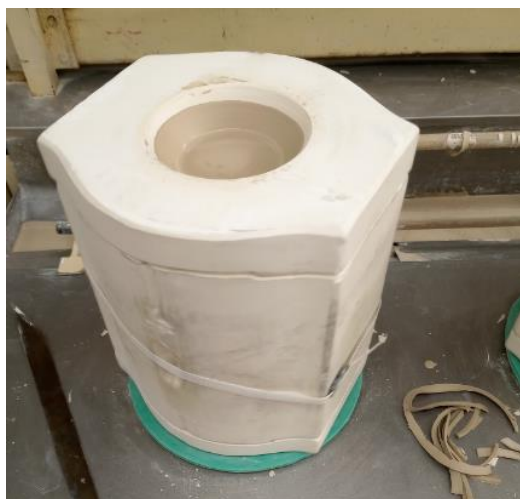
Figura 12 – Imagem de um molde de gesso cheio com barbotina no processo de conformação de peças de porcelana, por enchimento tradicional
