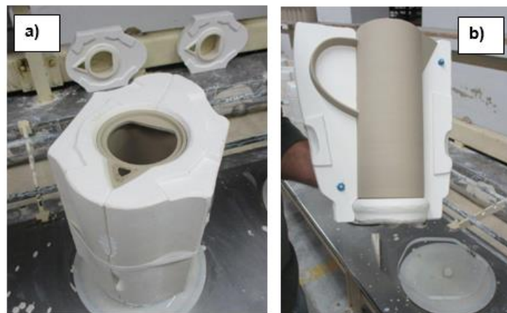
Figura 15 – processo enchimento tradicional: a) peça no interior do molde em gesso, b) a peça já tem a consistência para ser desmoldada, podendo ser retiradas as partes constituintes do molde (tampo, partes laterais e fundo)
