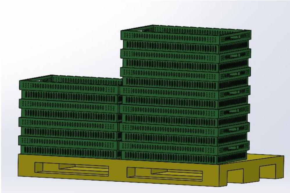
**Figura 18.** Disposição das caixas na paleta no segundo método de congelação sem produto. Armazenamento vertical.
