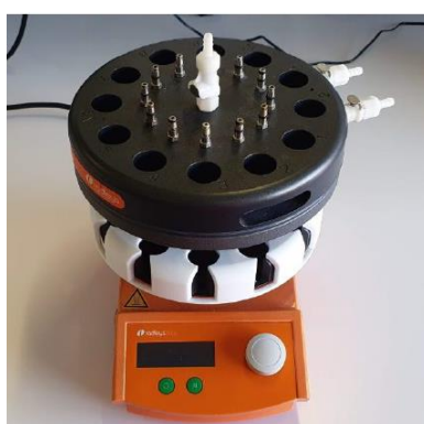
Figura 11 – Equipamento Carousel Radleys Tech utilizado no processo de extração dos pigmentos.
