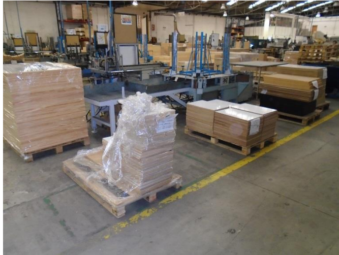
Figura 29 - Excesso de material junto à linha
