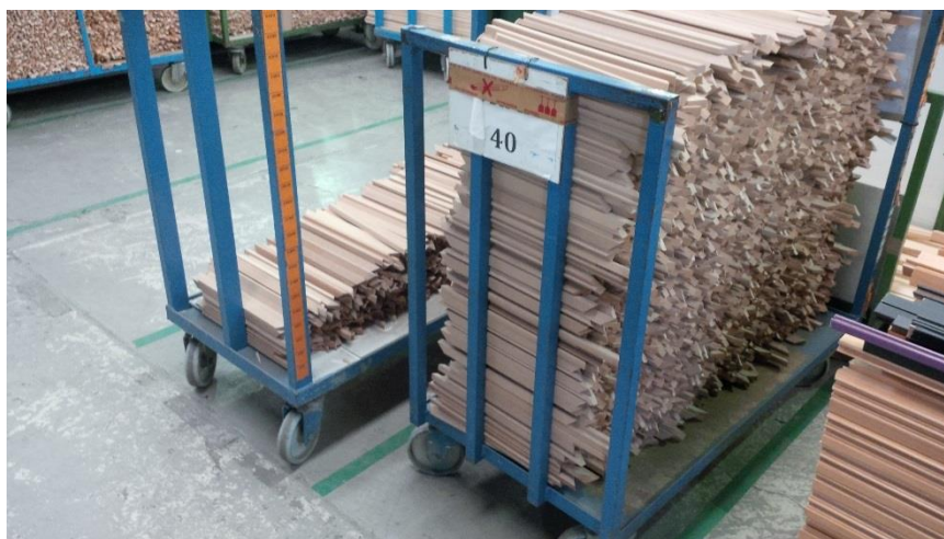
Figura 18 - Armazenamento de perfis cortados na montagem
