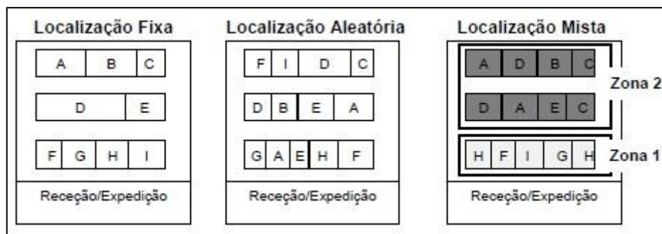
Figura 10 – Aplicação dos três diferentes métodos de arrumação a um armazém com 9 referências
