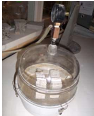
Figura 5.3: Exsicador ao vácuo com amostras dos GP porosos.
