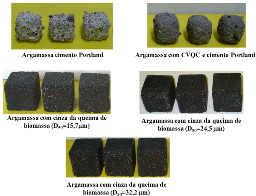
Figura 2.34: Aspeto dos provetes após 120 dias de imersão na solução de \text{H}_2\text{SO}_4 (3 % em volume) [135].
