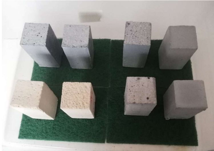
Figura 6.5: Provetes de AGPs usados no ensaio de absorção de água por capilaridade.
