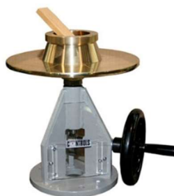
Figura 4.5: Mesa de espalhamento utilizada no ensaio de consistência das pastas.
