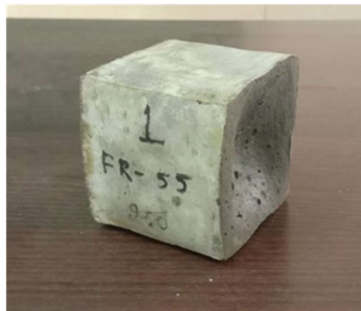
Figura 2.29: Aspecto do provete produzido com 50 % de CQCA e 50 % de CVQC após tratamento térmico a 800 °C numa mufla [115].
