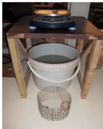
Figura 5.4: Montagem para realização da pesagem hidrostática.
