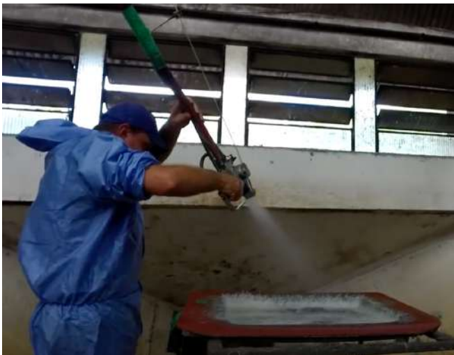
Figura 44 Aplicação do composto de resina e fibra de vidro
