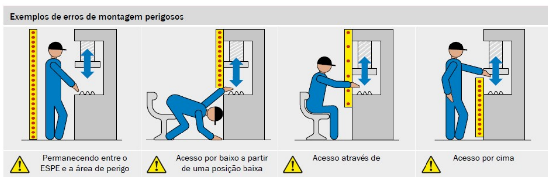
Figura 3.8: Exemplos de montagem incorreta de equipamentos de proteção eletrossensitivos. Retirado de [4].
