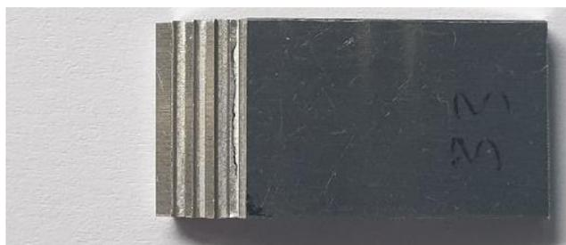
Figura 3.16 - Vista de fundo de provete do tipo 2 com 3 ranhuras de alumínio ensaiado.
