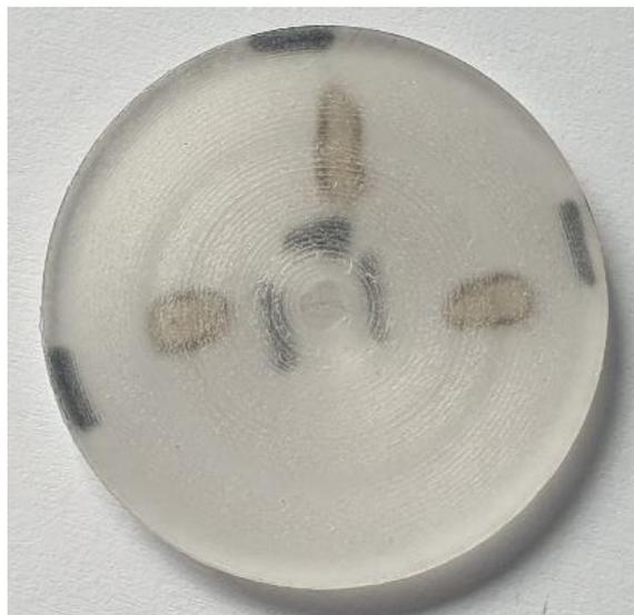
Figura 2.39 - PC com partes da superfície queimada.
