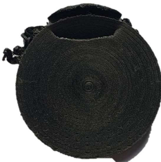
Figura 3.21 - Vista do fundo de provete de PA 66 reforçado do tipo 2 com 2 ranhuras.
