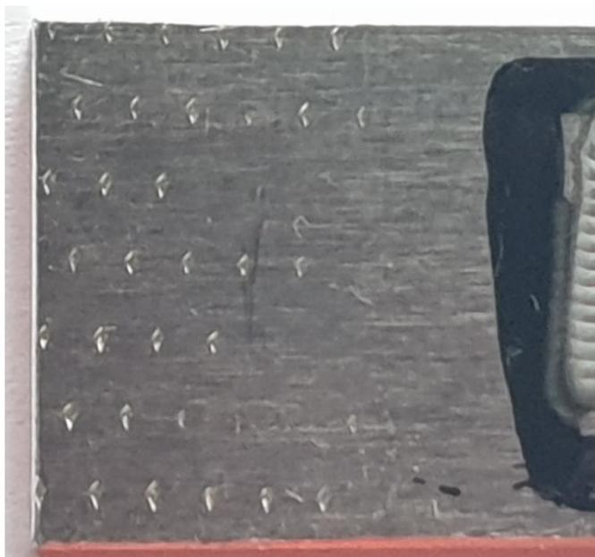
Figura 2.23 - Marcas após ensaio de tração.
