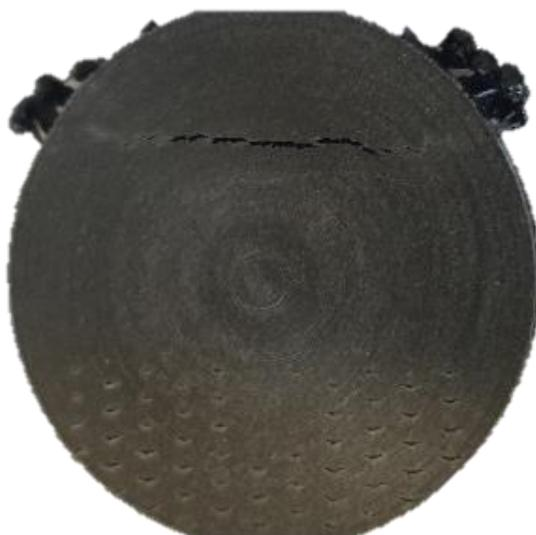
Figura 3.22 - Vista de fundo de provete de PA 66 reforçado do tipo 2 de 3 ranhuras.
