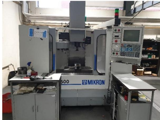
Figura 2.12 - Centro de maquinagem Mikron VCE-500.
