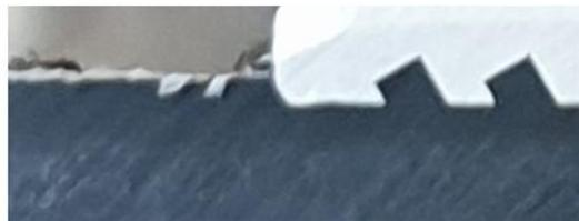
Figura 3.12 - Ranhuras de provetes de PA 6 do tipo 2 antes e após os ensaios.
