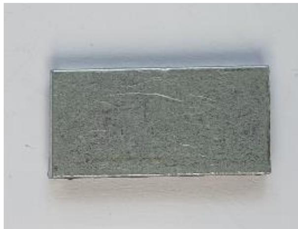
Figura 2.9 – Espaçador de 20 mm x 10 mm x 2,5 mm.
