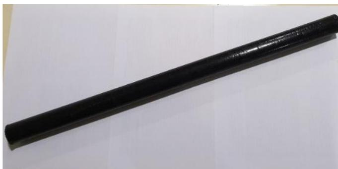
Figura 2.3 - Varão de ERTALON 66 GF30 de diâmetro 30 mm.
