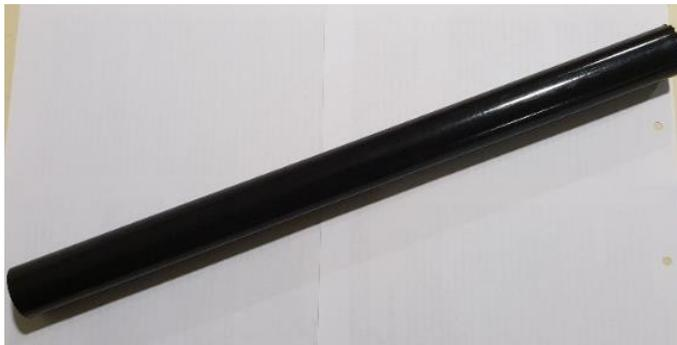
Figura 2.2 - Varão de ERTALON 6 SA de diâmetro de 30 mm.
