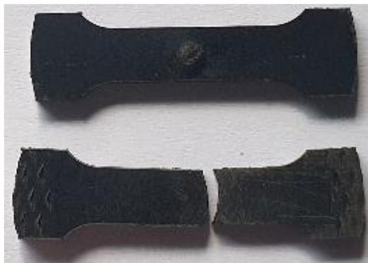
Figura 3.3 - Provette antes e após ensaio de ERTALON 66 GF30
