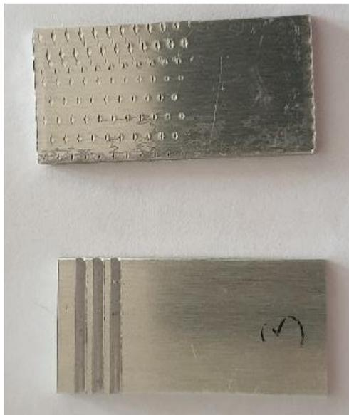
Figura 2.11 - Um provete com ranhuras e um provete marcado com pequenos pontos de forma aproximadamente piramidal tetraédrica, em baixo relevo.
