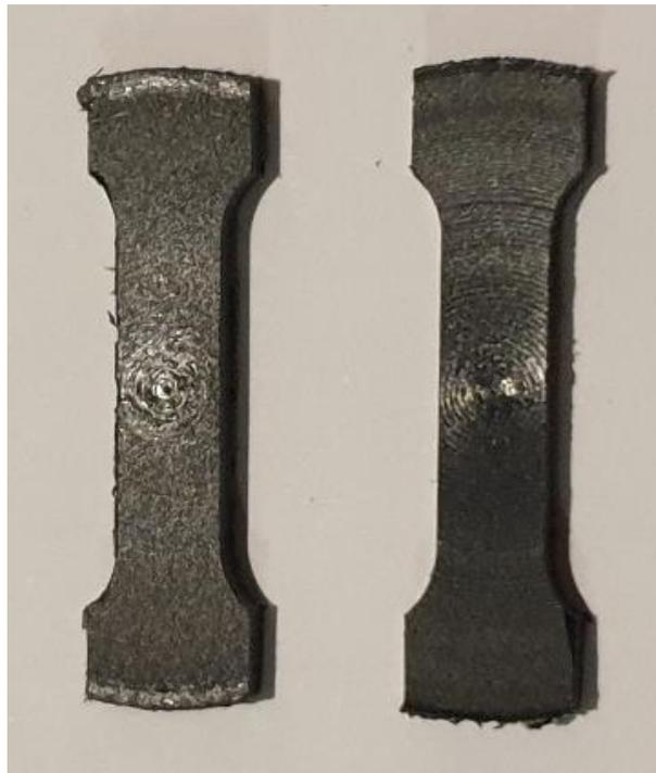
Figura 2.37 - Provete de ERTALON 66 GF30 e Provete de ERTALON 6 SA maquinados.
