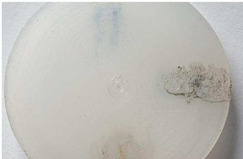
Figura 2.40 – PA 6 com partes da superfície queimada.
