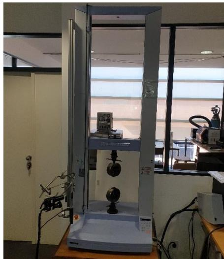
Figura 2.44 - Máquina de ensaios Shimadzu AGS-X10 kN.
