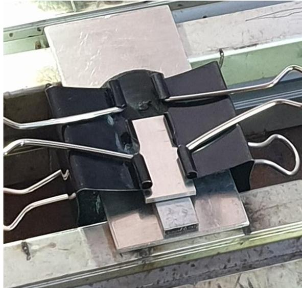
Figura 2.8 - Dispositivo de fixação posicionado.
