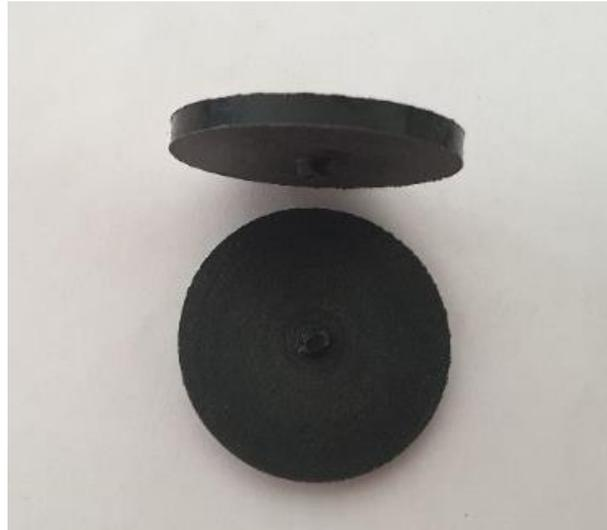
Figura 2.36 - Provete sangrados de ERTALON 66GF30.
