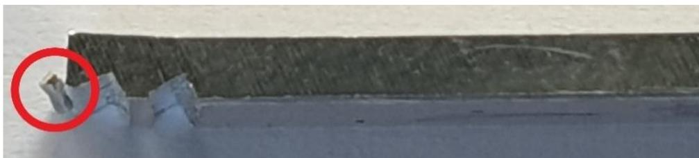
Figura 2.16 - Provete com rutura.
