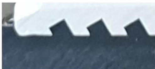
Figura 3.23 - Vistas laterais de provetes polidos antes e após ensaios do tipo 2 com 3 ranhuras.
