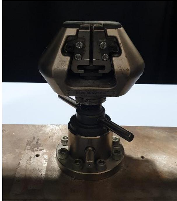
Figura 2.31 - Amarra em cunha montada na máquina de ensaios.
