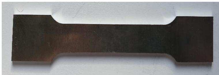
Figura 2.33 - Provete de alumínio maquinado para caraterização do material.
