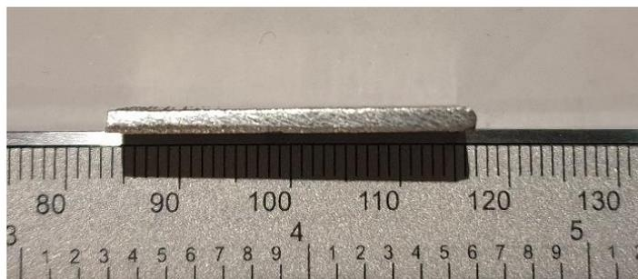
Figura 3.25 - Provette marcado e soldado a ERTALON 6 SA de alumínio após o ensaio.
