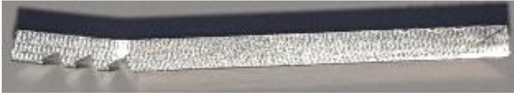
Figura 3.24 - Provete de alumínio do tipo 2 com 3 ranhuras após ensaio.
