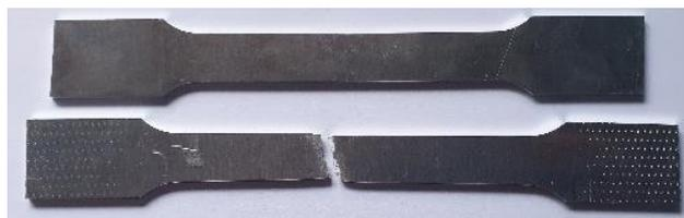
Figura 3.1 - Provette testado e não testado de alumínio EN AW-6082-T6.
