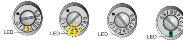
Figura 5.7: Potenciómetro do sensor Contrinex RLS-1181-020 RWM, adaptado de [42].
