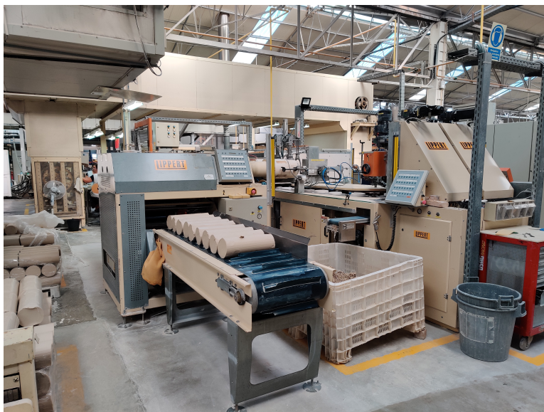
Figura 2.6: Etapa inicial de uma linha de produção de chávemas que utiliza os charutos de pasta.
