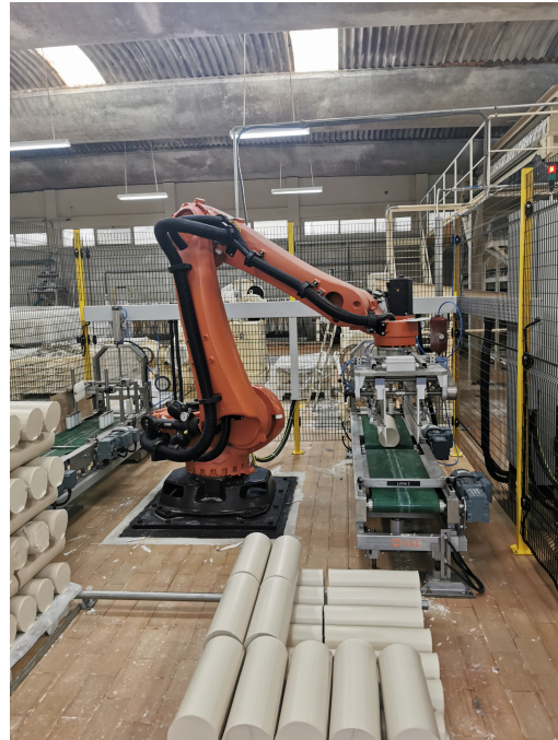
Figura 2.4: Robô paletizador de "charutos".
