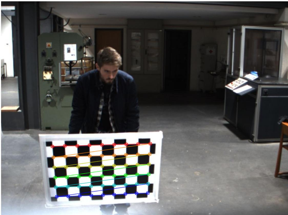
Figura 4.3: Exemplo da utilização da função de deteção do xadrez na imagem de uma câmara
