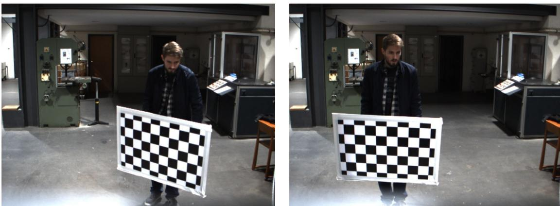
Figura 4.6: Duas das imagens retiradas da câmara do lado direito, utilizadas em duas das dez calibrações
