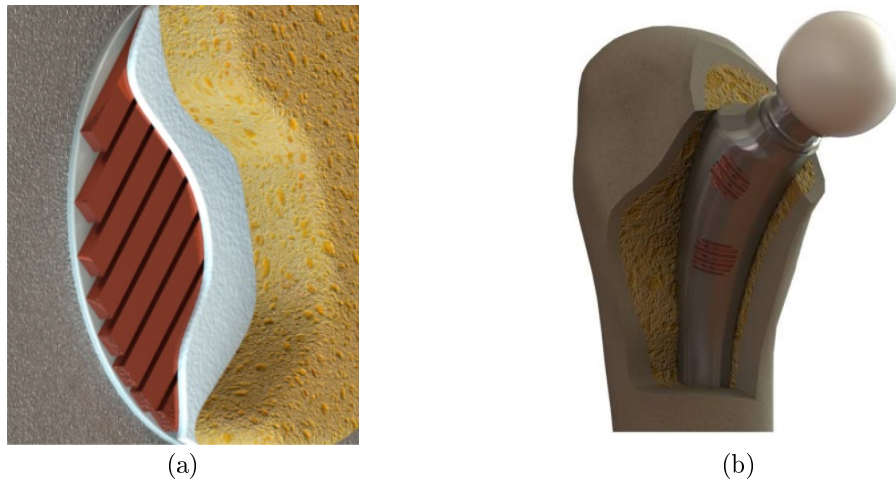
Figura 3.4: Conceito do estimulador capacitivo em co-superfície com padrão listrado [36]. a) Exemplo da configuração dos elétrodos; b) Exemplo de implante instrumentado da anca, com capacidade de controlar o estado fixação osso-implante.
