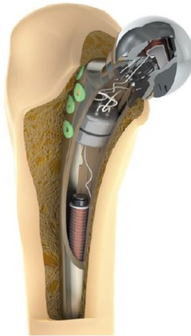
Figura 1.7: Ilustração do conceito de implante ativo instrumentado. Adaptado de [27].
