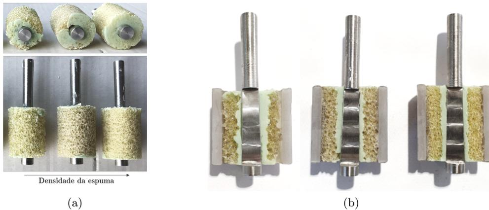
Figura 5.2: Em (a) as amostras finais, após a polimerização. Em (b) as amostras seccionadas para os ensaios de tração e correlação cruzada digital de imagem. Da esquerda para a direita: espuma 7,5 PCF, 10 PCF e 12 PCF.
