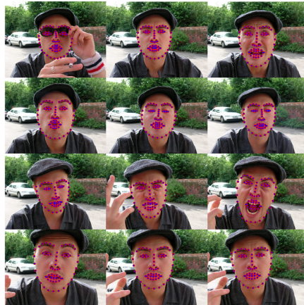
Figura 2.15: Detecção de marcos faciais utilizando a ferramenta OpenFace.
