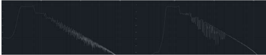
Figura 6.41: Sweep da onda dente de serra do protótipo ao longo da oitava 0 à esquerda e oitava 1 à direita.
