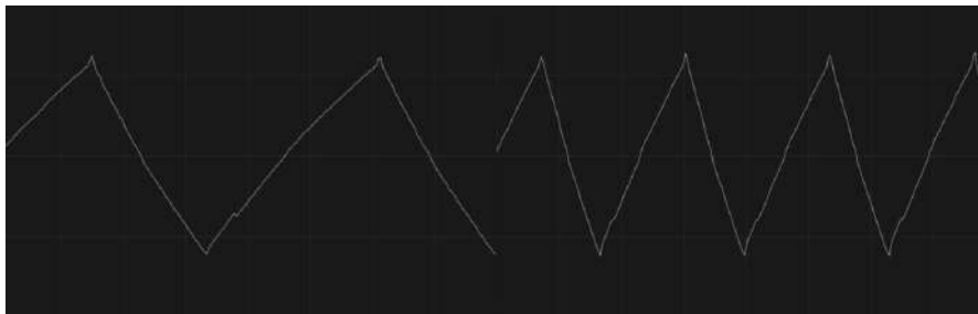
Figura 6.49: Onda triangular do protótipo com a frequência da nota C1 à esquerda e C2 à direita.
