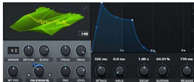
Figura 4.10: No parâmetro com legenda FM (FROM B) pode ver-se como é possível, no Serum, associar o envelope da direita a qualquer parâmetro, definindo um centro da modulação e o ganho, ou amount , a azul, numa interface elegante. À direita, o método de desenhar um envelope com pontos de Bezier.
