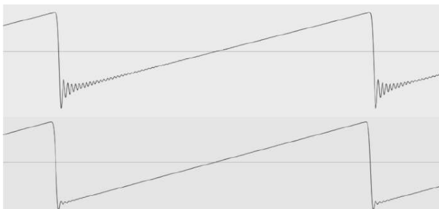
Figura A.3: Em cima a onda original e em baixo a versão com declive. De notar que bem mais evidente do que a presença do declive são os harmónicos na onda original após a descontinuidade.
