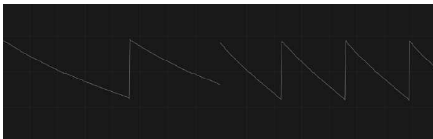
Figura 6.44: Onda dente de serra do protótipo com a frequência da nota C1 à esquerda e C2 à direita.
