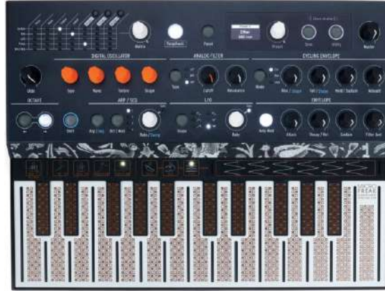
Figura 4.2: O Microfreak da Arturia associa um layout mais tradicional a uma tecnologia de toque capacitivo, onde a intensidade da nota será proporcional à área do dedo em contacto com o teclado. [31]
