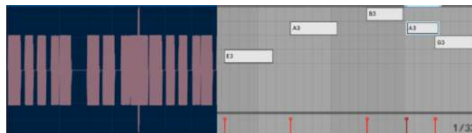
Figura 3.9: Um exemplo de uma melodia com tendência monofónica tocada num sintetizador polifónico, o que permite a existência de sobreposição acidental de notas. À esquerda pode-se ver claramente um pico de amplitude na breve sobreposição entre as duas últimas notas da sequência midi da direita.
