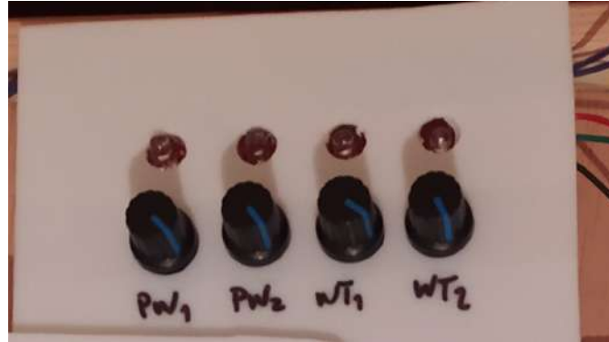
Figura G.13: Protótipo final - Painel do gerador de CV entre -12V e +12V.
