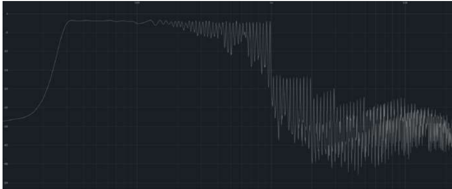
Figura 6.48: Sweep da onda triangular do protótipo ao longo de todas as oitavas.
