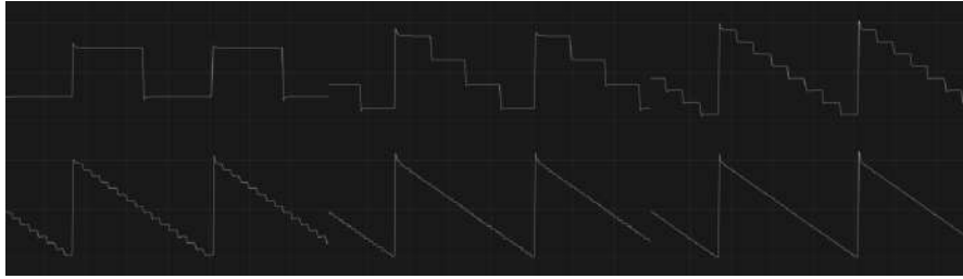
Figura 5.10: O resultado teórico das ondas da Figura 5.7 à medida que estas são somadas com a iteração anterior.
