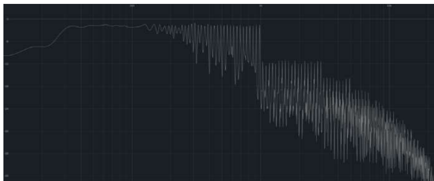
Figura 6.38: Sweep da onda quadrada do protótipo ao longo de todas as oitavas.
