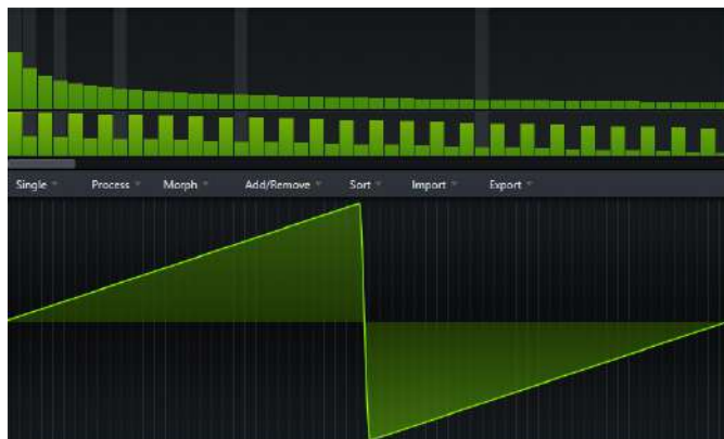
Figura A.2: Substituição da descontinuidade numa onda dente de serra por um segmento com formato exponencial e dimensão f/64 , utilizando o modo Table Editor do Serum. De notar, em cima, o resultado da suavização de todos os harmónicos e uma mudança progressiva da fase ao longo do espectro de frequências.
