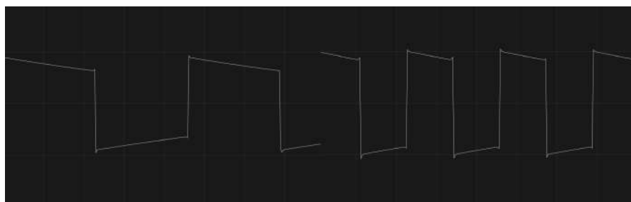
Figura 6.39: Onda quadrada do protótipo com a frequência da nota C1 à esquerda e C2 à direita.
