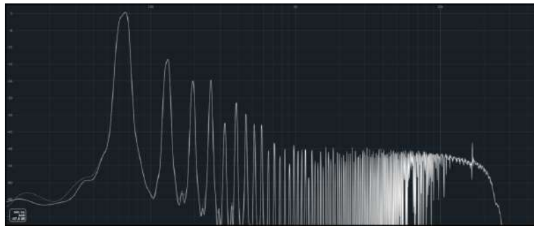
Figura 6.15: Transformada de Fourier da onda triangular do protótipo em midi C1.
