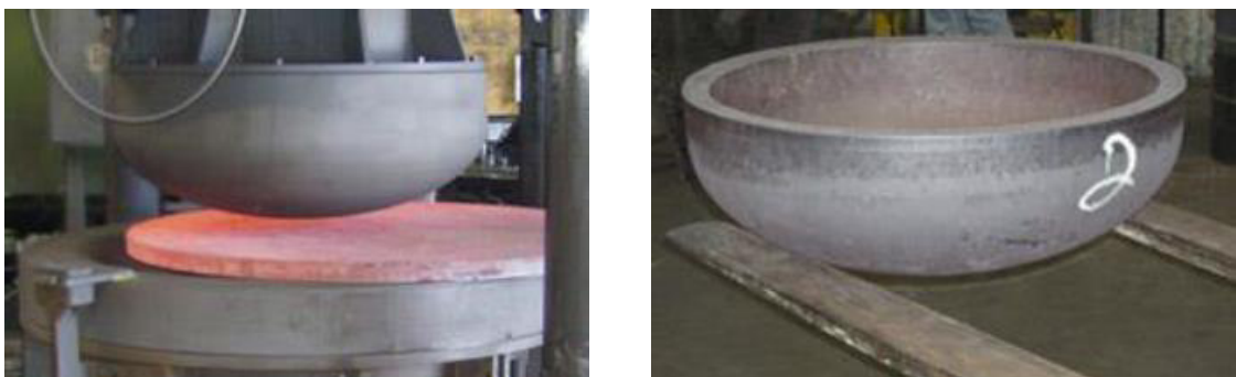
Figura 14 - Ferramenta de punçoamento (a) [18] e fundo conformado (b) [18]
