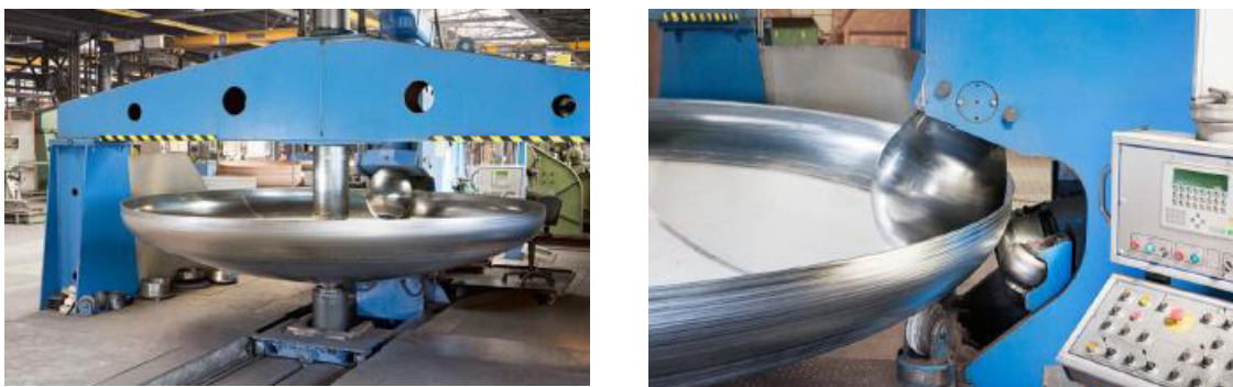
Figura 13 – Pórtico de equipamento de Flanging (a) [17] e ferramenta de conformação (b) [17]
