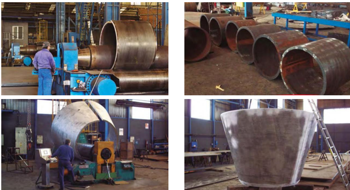
Figura 4 - Exemplos de conformação de virolas cilíndricas e cones
