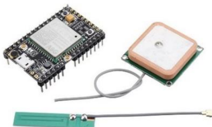
Figura 30 – Módulo de Comunicações A9G com antenas GPS e GSM/GPRS
