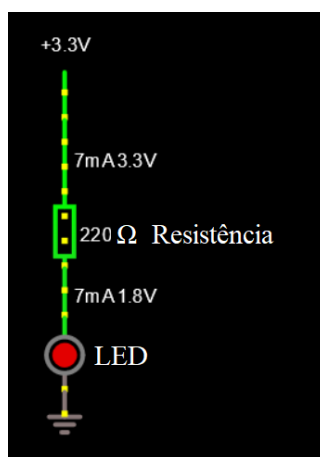
Figura 37 – Esquema de alimenta\^ao do LED, adaptada de (57)
