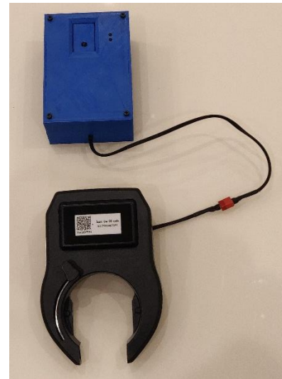
Figura 64 – Caixa final fechada e ligada ao aloquete
