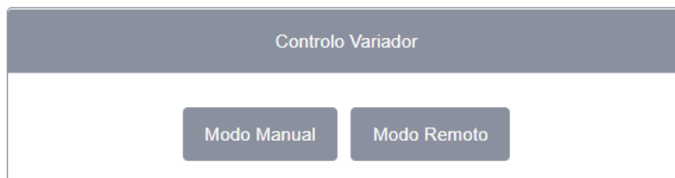
Figura 5.14: Caixa de controlo dos modos de funcionamento do variador de frequência.
