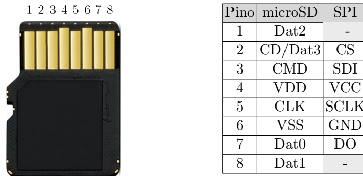
Figura 4.18: Descrição dos pinos de um cartão microSD [77].
