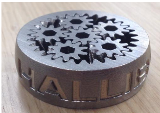
Figura 2.8: Peça de demonstração para a indústria petrolífera produzida pela Halliburton por FA [21]
