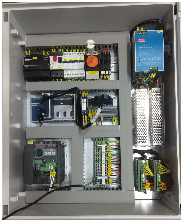
Figura 4.9: Layout da platine do quadro elétrico da máquina
