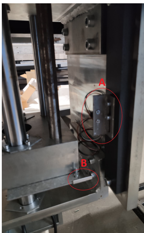
Figura 4.8: Pormenor de aplicação do sensor óptico numa plataforma
