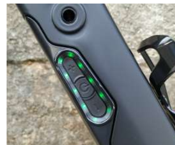
fig. 43 - Detalhe da Bateria montada no quadro
