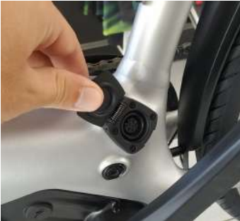
fig. 40 - Detalhe entrada tomada de carregamento
