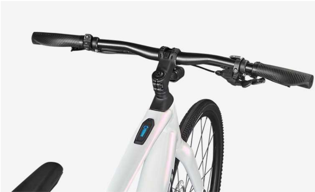
fig. 41 - Detalhe do indicador de bateria incorporado no quadro e do seletor de modos de condução no lado esquerdo do guiador
