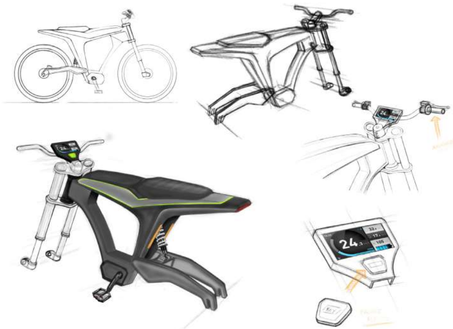
fig. 68 - Esboços de detalhe do conceito
