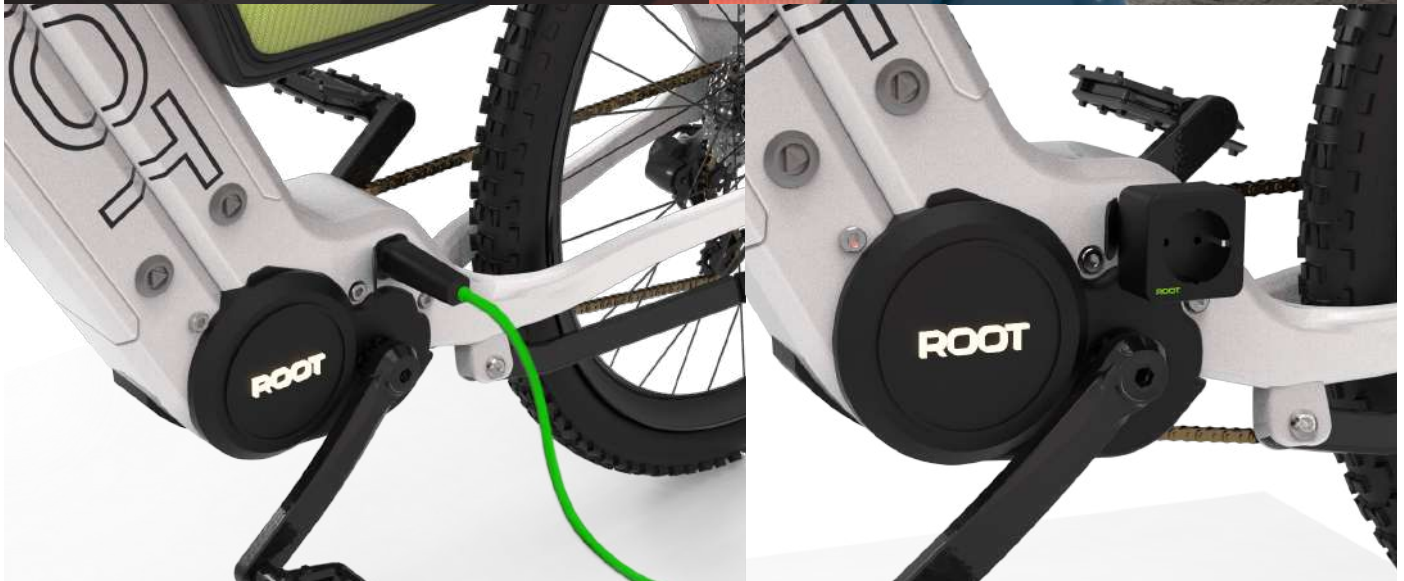
fig. 174 - Entrada de carregamento das baterias
