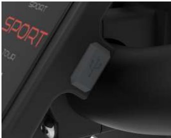
fig. 141 - Detalhe porta USB instalada no Painel de Controlo
