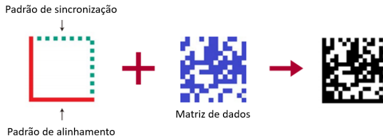
Figura 2.7: Estrutura do código DataMatrix. Adaptado de (24)
