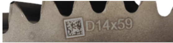
Figura 7.1: Resultado final da marcação laser do código DataMatrix nas coroas
