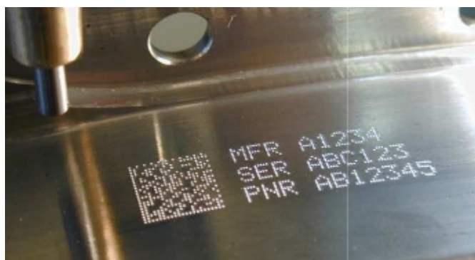
Figura 2.11: Exemplo duma peça marcada com a tecnologia dot peening (35)
