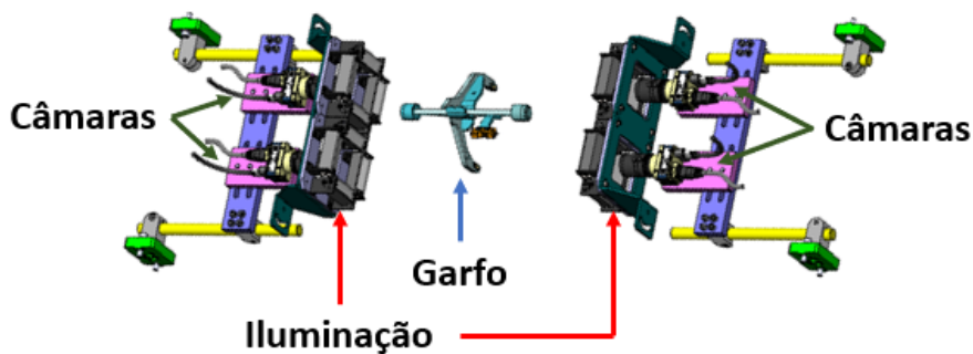
Figura 5.4: Disposição das câmaras e da iluminação em cada posto de controlo visual (rodado +90° em relação à disposição real)
