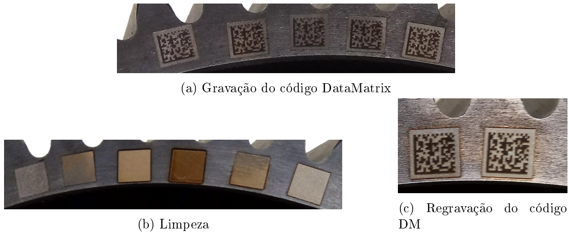
Figura 4.11: Testes de gravação para se obter os parâmetros ideais da aplicação laser
