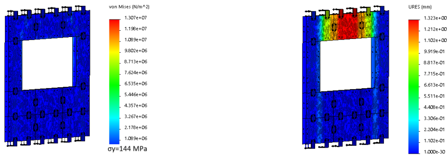
Figura 4.24: Análise da representação da parede com janela, com as tensões e os deslocamentos representados.
