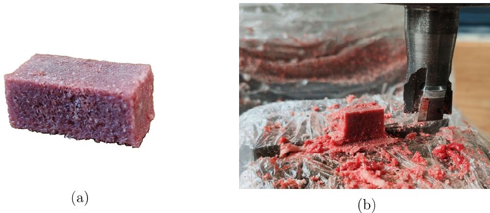
Figura 4.6: Preparação das amostras porcinas. a) Amostra final; b) Maquinação da face das amostras ósseas utilizando uma fresadora.
