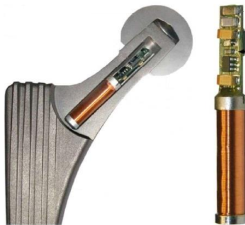
Figura 1.5: Arquitetura geral de implantes passivos instrumentados [29]
