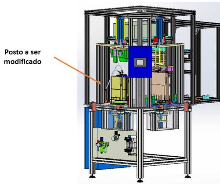
Figura 4.1: Equipamento de estanquidade antes das modificações.
