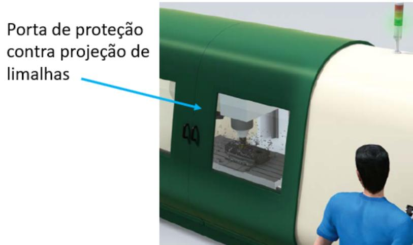
Figura 3.10: Proteção contra a projeção de limalhas [12].
