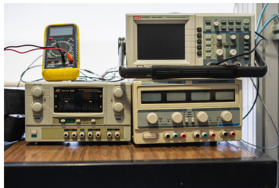
Figura 3.9: Fontes de alimentação, multímetro e osciloscópio utilizados.
