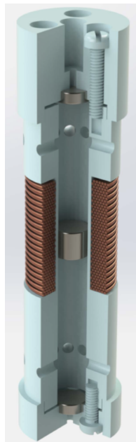
Figura 2.5: Esquemático representativo do gerador eletromagnético proposto por Soares dos Santos et al. [16].
