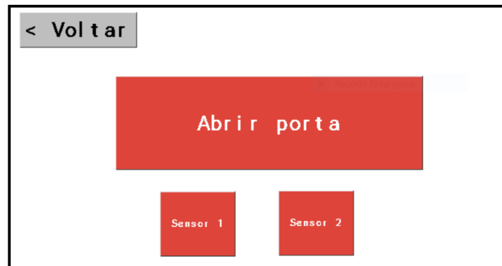
Figura 6.10: Ecrã do HMI onde se visualiza o estados dos sensores da fase 4
