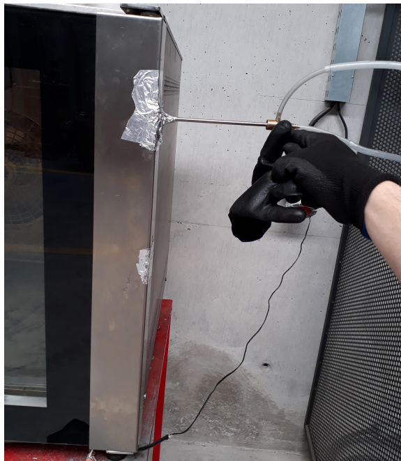
Figura 5.16: Tubo de Pitot colocado no interior da calha do lado direito da porta do forno, por meio do furo F1.
