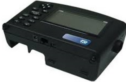
Figura 4.6: Micromanómetro utilizado para a medição da velocidade do ar. Adaptado de [7].
