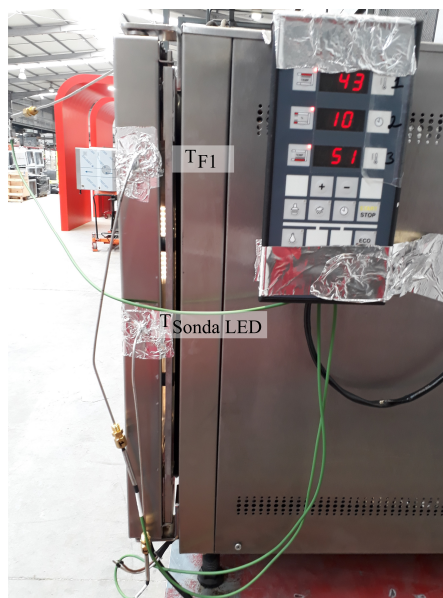
Figura 5.7: Setup para medição das temperaturas nos dois furos laterais da calha direita.
