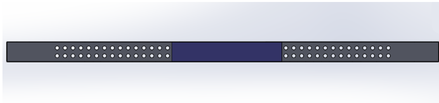
Figura 5.13: Exemplo de um dos estados da furação inferior utilizada neste teste.
