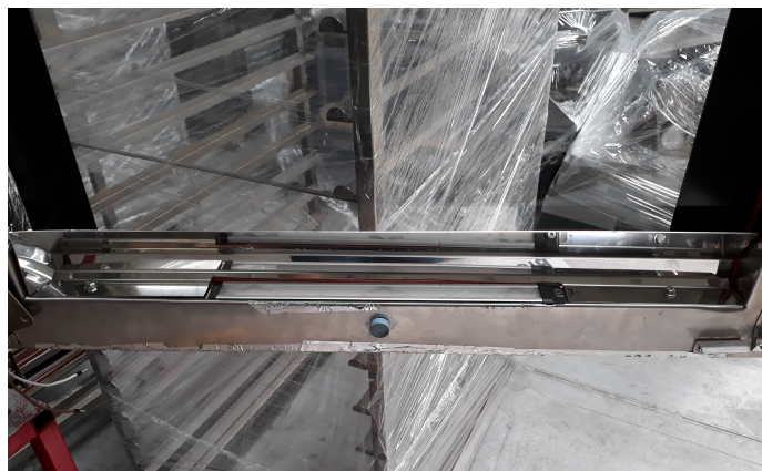
Figura 6.16: Aplicação real da luminária LED na zona inferior da porta.
