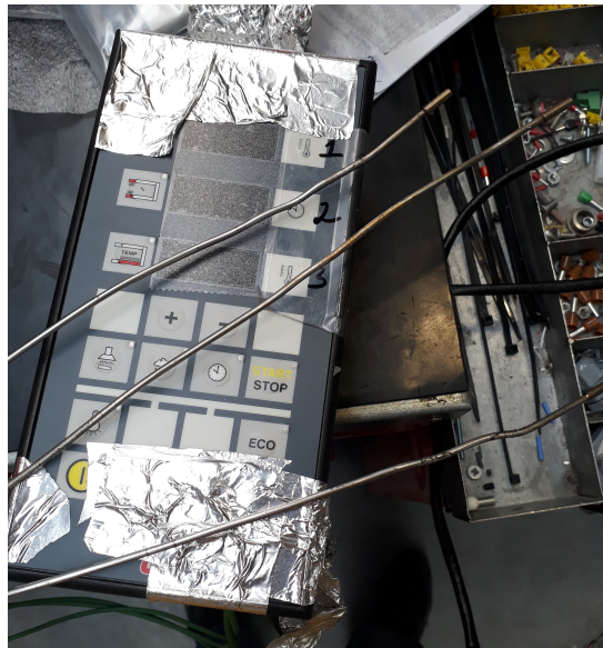
Figura 4.5: Equipamento utilizado para realizar medições de temperaturas na Ramalhos .
