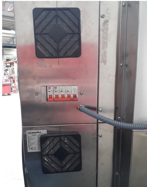
Figura 9.6: Aberturas na traseira do forno Modulram .
