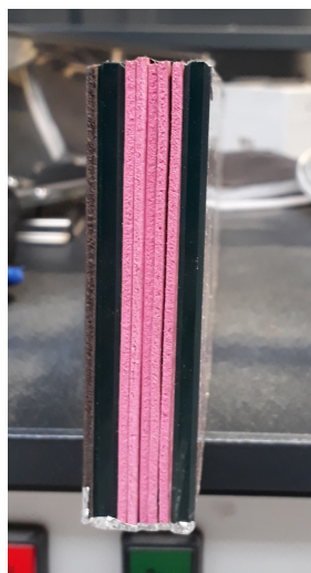
Figura 9.7: Vista lateral do vidro duplo aplicado.
