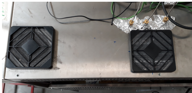
Figura 9.5: Aberturas na cobertura do forno para saída de ar quente.
