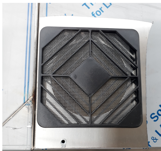
Figura 7.4: Furação atual na lateral direita do forno Modulram .
