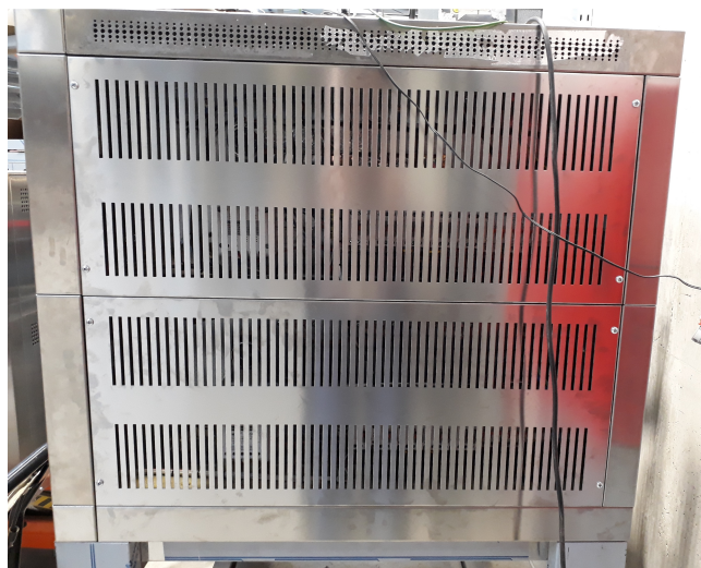
Figura 9.4: Lateral direita do forno Modulram com chapas de rasgos retangulares.
