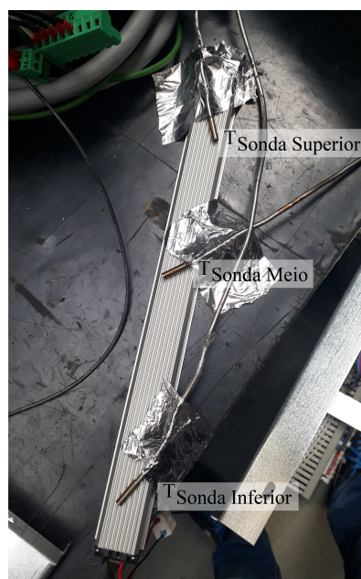
Figura 6.10: Setup para a medição de temperaturas no dissipador de calor da luminária BJB 77.116.1005 .
