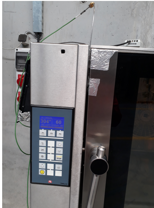
Figura 5.8: Pormenor da zona do fecho da porta, evidenciando a dificuldade presente para a medição de temperaturas nesta região.
