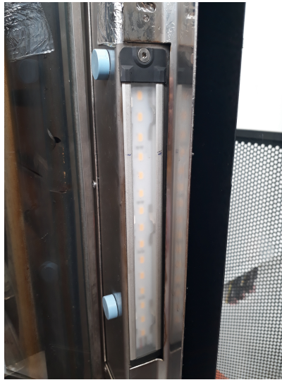
Figura 4.1: Aplicação da luminária LED BJB 77.116.1002.36 no lado da dobradiça da porta.
