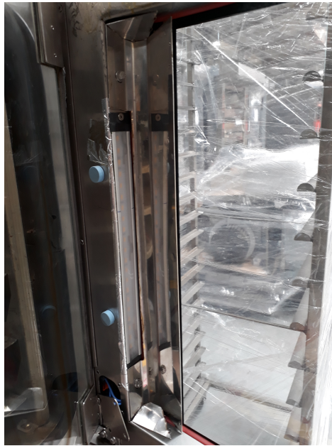
Figura 6.11: Aplicação da nova luminária no lado da dobradiça da porta, com um refletor cujo ângulo de reflexão é de 155^\circ .
