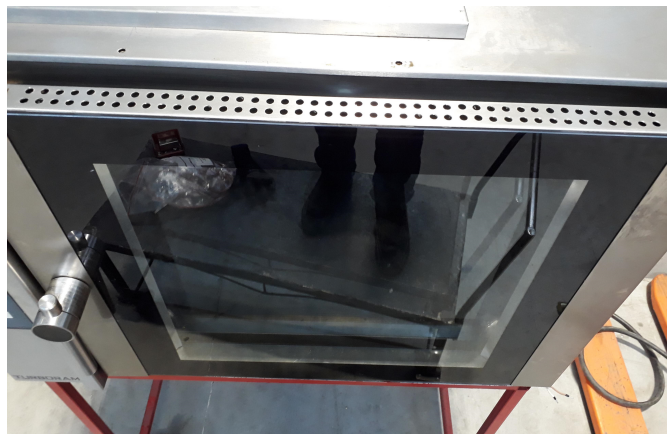
Figura 4.3: Furação superior inicial, com 2x43 furos de diâmetro 7 mm.
