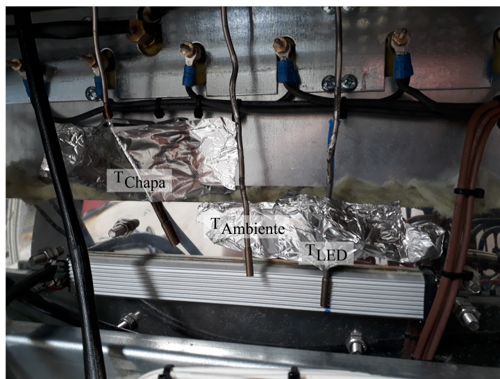
Figura 8.6: Posicionamento das sondas para a realização dos ensaios no forno Modulram .
