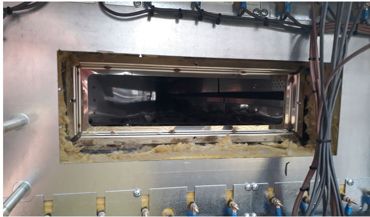
Figura 8.4: Placas laterais direitas alteradas de forma a colocar a nova cavidade de iluminação.
