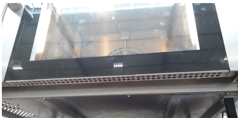
Figura 5.15: Nova furação inferior com 86 furos com diâmetro de 10 mm.
