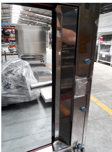
Figura 6.14: Refletor no lado do fecho da porta que permite a reflexão da fração de luz que chega a esta zona para o interior do forno.
