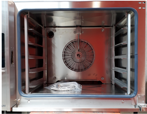
Figura 5.6: Assimetria da porta do Turboram em relação à câmara do forno.
