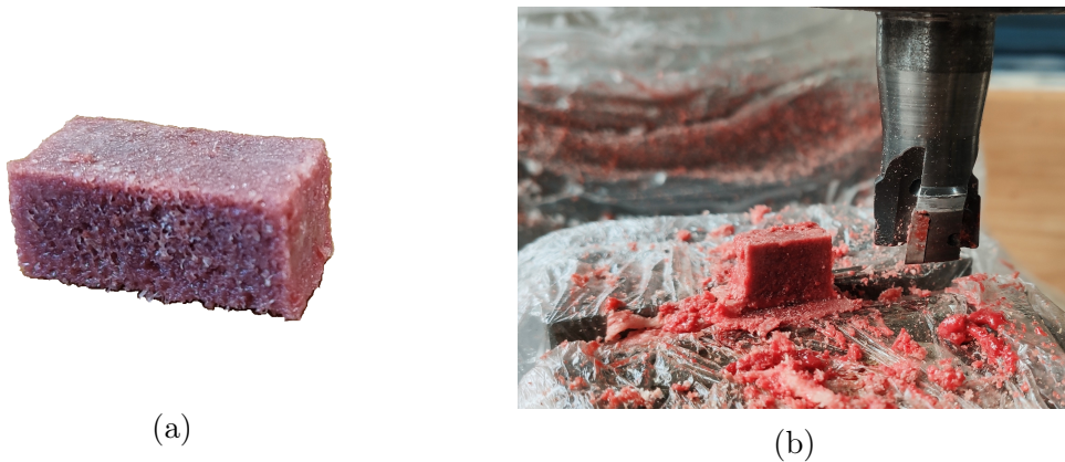
Figura 5.7: Preparação das amostras porcinas. a) Amostra final; b) Maquinação da face utilizando uma fresadora.
