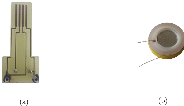
Figura 5.9: Sensores de monitorização usados nas validações experimentais. a) arquitetura-EPL[50]; b) arquitetura-HIC-qP.
