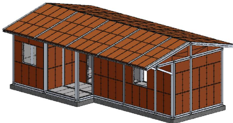
Figura 3.15 – Preenchimento das laterais e conclusão estrutural da habitação.
