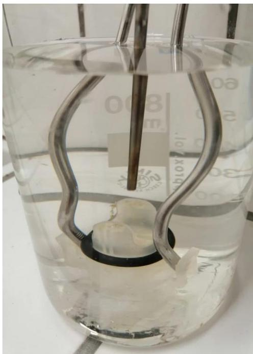
Figura 35: Ponta ultrassônica introduzida no gobelé com água para libertar as ondas
