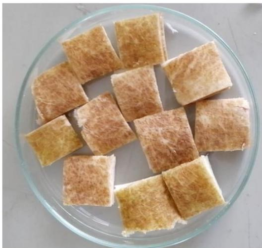
Figura 18: Amostras do filtro de polipropileno com presença de biofilme
