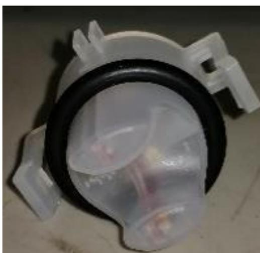
Figura 30: Representação do sensor de ótico completo após 1 semana em água limpa
