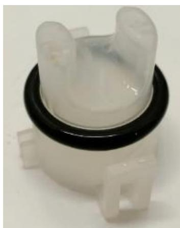
Figura 36: Casing do sensor ótico após a limpeza
