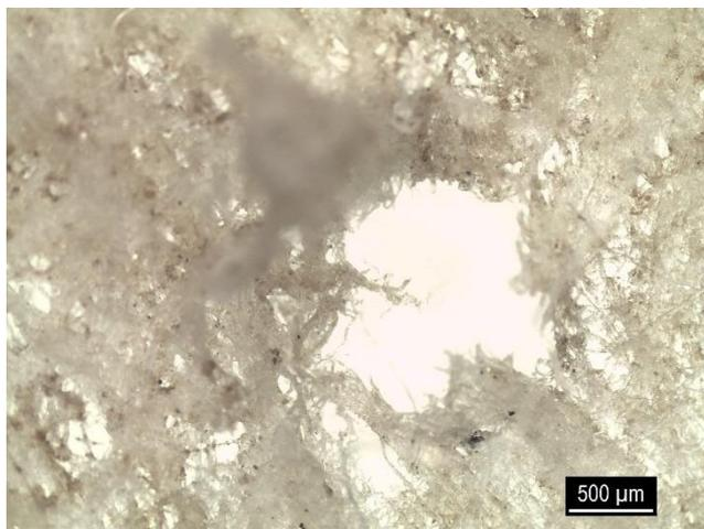
Figura 27: Amostra do filtro de polipropileno a 1 cm do raio de ação do ultrassom após 1 mês
