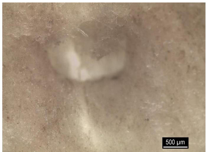
Figura 26: Amostra do filtro de polipropileno a 3 cm do raio de ação do ultrassom
