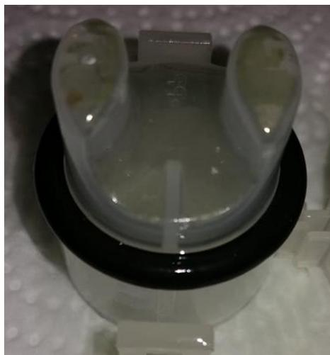
Figura 31: Superfície do sensor coberta de biofilme
