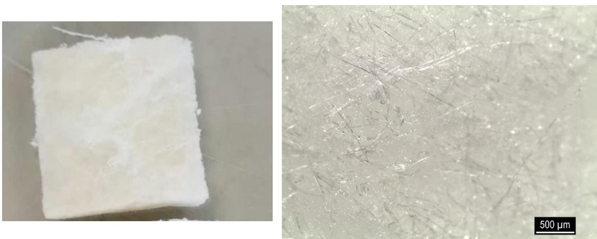
Figura 24: Amostra do filtro de polipropileno a 1 cm do raio de ação do ultrassom
