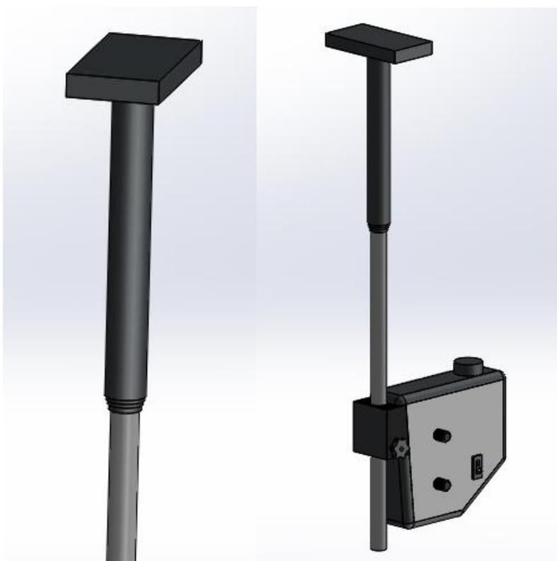
Figura 56: Representação do suporte do aparelho ultrassónico com haste extensível
