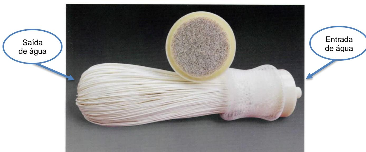
Figura 15: Representação da membrana de ultrafiltração
