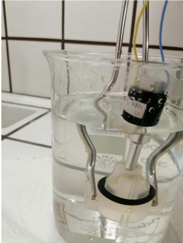
Figura 41: Colocação da ponta ultrassónica da american piezo
