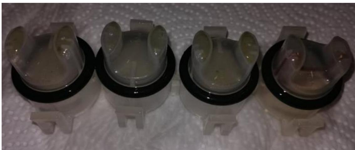
Figura 32: Todas as amostras com presença de biofilme
