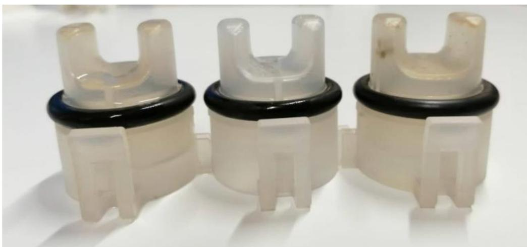
Figura 38: Vista de cima da diferença dos dois casings que não foram limpos (esquerda e direita) e o que foi (meio).
