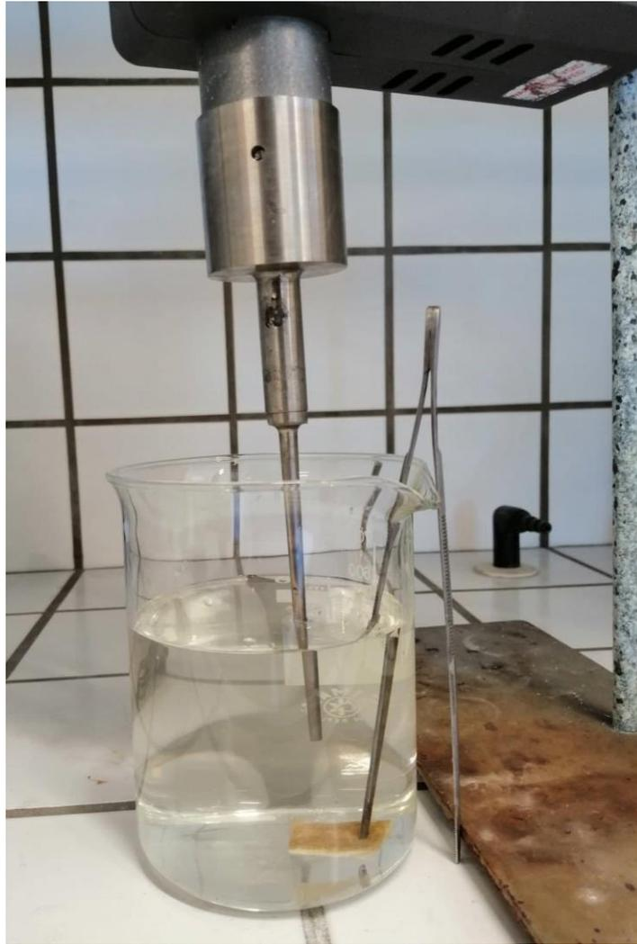
Figura 22: Inserção da amostra de biofilme dentro do gobelé com água
