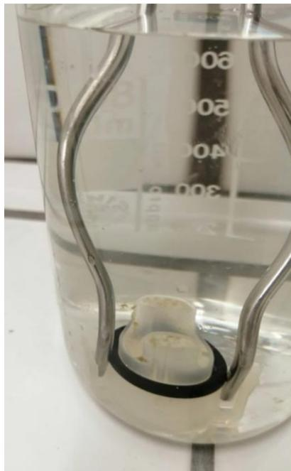
Figura 34: Pinça a segurar o casing do sensor ótico para a limpeza ultrassónica
