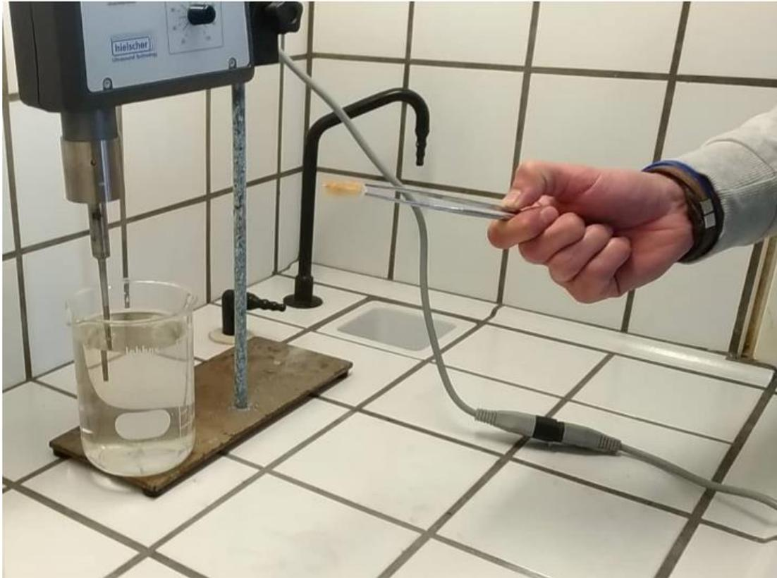
Figura 21: Colocação da amostra de biofilme presente no filtro de polipropileno para ser estudada no ultrassom
