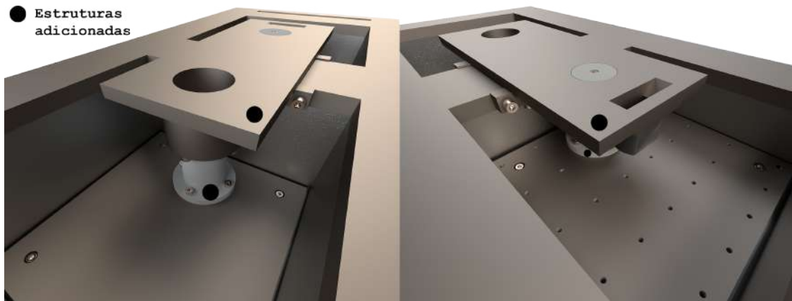
Figura 2.5: Montagem da nova mesa de trabalho.
