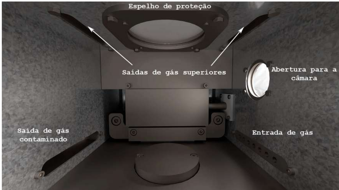
Figura 3.19: Interior da câmara de trabalho.
