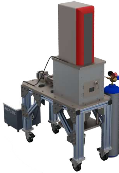
Figura 3.1: Novo design da máquina DMLS.
