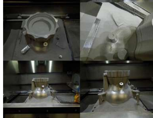
(b) Fabrico de um componente da câmara de combustão do foguete SuperDraco da SpaceX, usando Direct Metal Laser Sintering (DMLS) [5].
