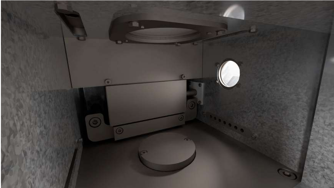
Figura 3.11: Varredor no interior da câmara de fabrico.
