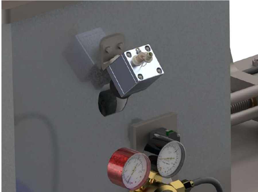
Figura 3.32: Instalação da câmara de infravermelhos.
