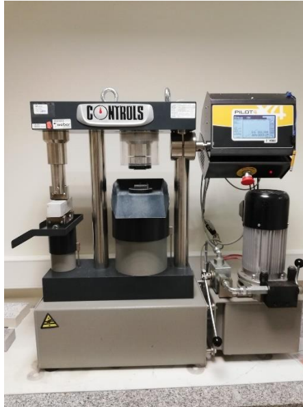
Figura 13 - Equipamento de avaliação de resistência mecânica da marca CONTROLS, modelo 65-1142, gama de medição de 2-15 kN e resolução de 0,01 kN para a flexão e gama de medição de 30-300 kN com resolução de 0,1 kN para a compressão.
