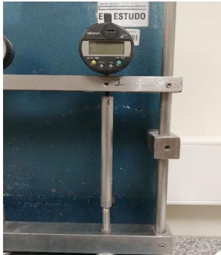
Figura 12 - Retratômetro da marca Mitutoyo Corp. e modelo ID-C112B com gama de medição de 0,001mm.
