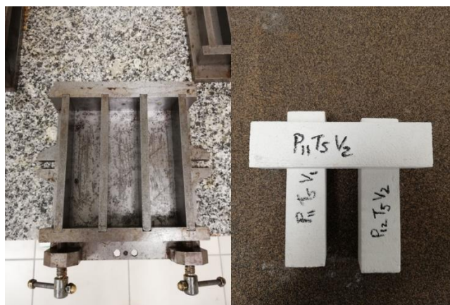
Figura 10 - Moldes específicos respeitando a norma EN 1015-11, que devem ser de metal aberto com paredes removíveis formando 3 compartimentos quando montado de dimensões de 4 \times 4 \times 16 \text{ cm}^3 (tolerância de \pm 0,1 \text{ mm} para a largura e profundidade, e de \pm 0,4 \text{ mm} para o comprimento) e os provetes resultantes do desmolde, á direita.
