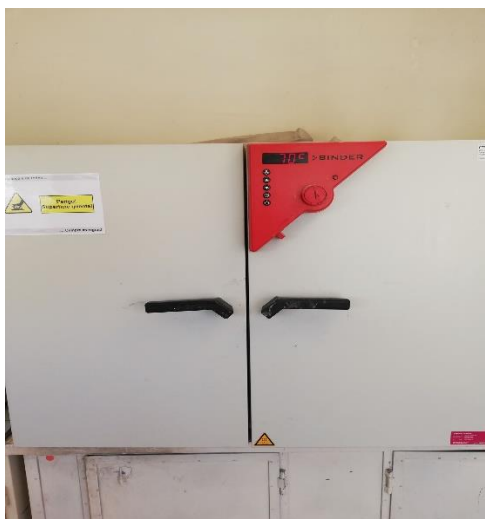
Figura 11 - Estufa operando a 70 \pm 5^\circ\text{C} , de marca Termolab, modelo ES-6, com gama de medição 0-250^\circ\text{C} e resolução de 1^\circ\text{C} , critério de aceitação \pm 5^\circ\text{C} .
