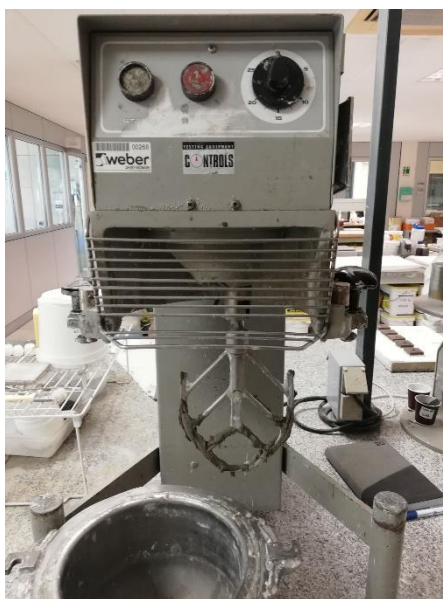
Figura 9 - Amassadora com características segundo a norma NP EN 196-1 (CEN, 2006a), marca Controls, modelo 65-L0005, com âncora de altura 130 \pm 1 mm, pá de altura 179 \pm 1 mm e diâmetro de recipiente 200 \pm 1 mm, com uma agitação de 140 \pm 5 rotações por minuto.
