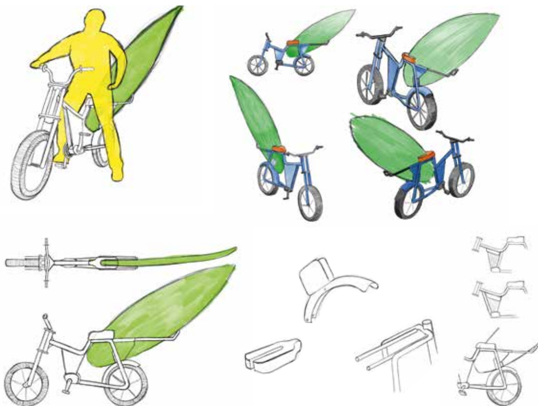
fig. 121 - Conceito prancha em posição paralela ao quadro.
