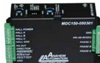
fig. 192 - Controlador de velocidade para motores BLDC, valor de tensão inferior a 50v
