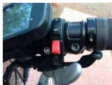
fig. 194 - Exemplo de acelerador regulável.
