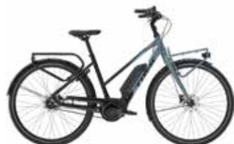
Marca: Trek Modelo: UM2+ Stagger Material: Alumínio Alpha Smooth Valor: 2.300
