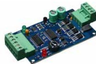
fig. 191 - Controlador de Motores CC com potência nominal de 250W
