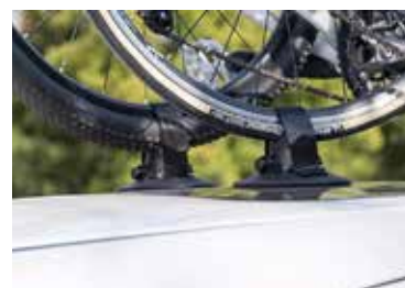
fig. 124 - Exemplo de suporte de bicicleta por vácuo.
