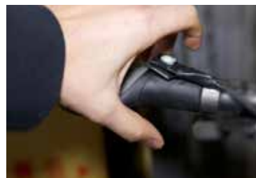
fig. 193 - Exemplo de acelerador por botão.
