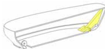
fig. 159 - Dobradiça entre a carcaça e a base do selim.
