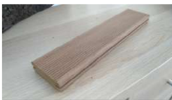
Figura 108 – Deck exterior, em ipê.
