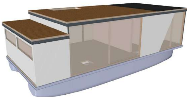
Figura 183 – Passo 7 do processo produtivo, telhado e pavimentos exteriores.
