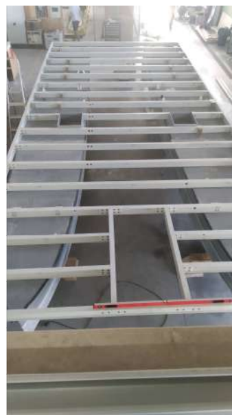
Figura 93 – Estrutura base da Waterlily.
