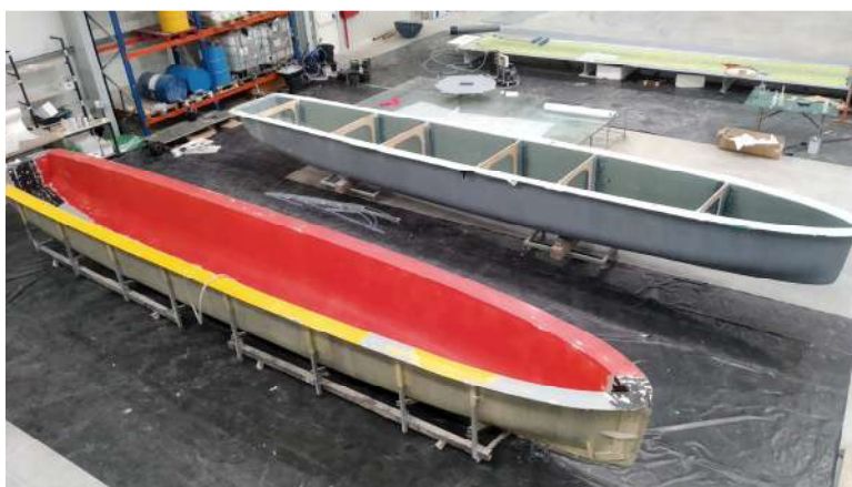
Figura 92 – Da esquerda para a direita, o molde dos cascos, o casco já retirado do molde e a tampa do casco, ainda em fase de infusão.
