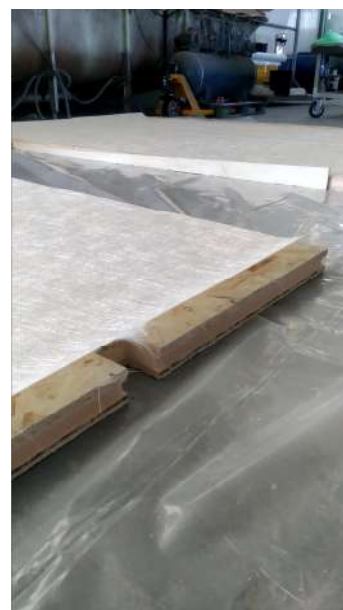
Figura 99 – Placas sandwich prontas a serem fibradas.
