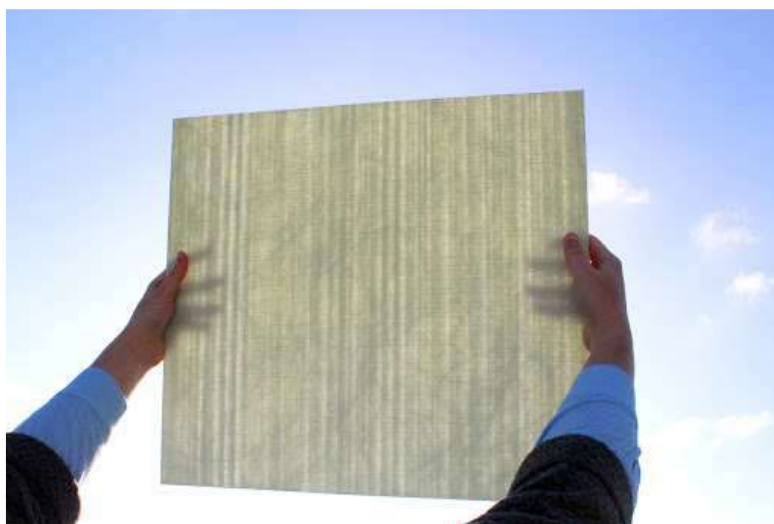
Figura 166 – Lay Light, um material composto por fibra de vidro e uma matriz translúcida.
