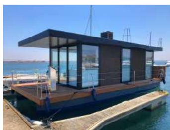
Figura 170 – Waterlily, versão Outdoor com plataforma extensível na ré, Costa Nova, Aveiro.
