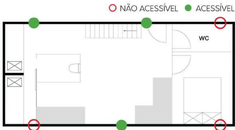
Figura 14.7 – Disposição atual da planta que bloqueia o acesso a três dos seis pontos de amarração necessários.
